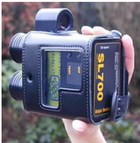
7 pav. Unipar SL 700 lazerinis TP važiavimo greičio matavimo prietaisas.
