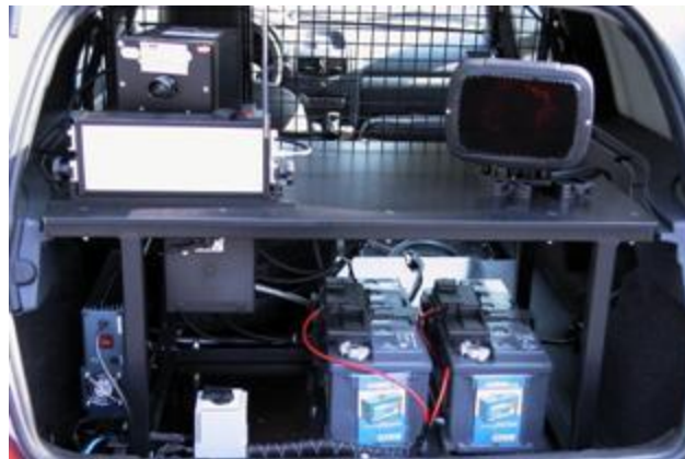
6 pav. MultaRadar C mobilus radiolokacinis TP važiavimo greičio matavimo prietaisas.
