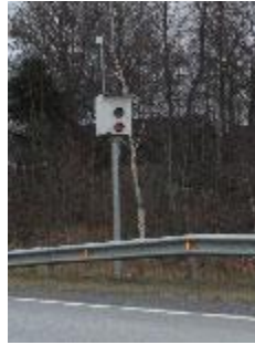
5 pav. MultaRadar S580 stacionarus radiolokacinis TP važiavimo greičio matavimo prietaisas.
