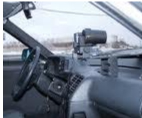
4 pav. Berkut VIZA mobili radiolokacinė TP važiavimo greičio matavimo ir vaizdo fiksavimo sistema.
