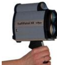
8 pav. Traffi Patrol XR – lazerinis TP važiavimo greičio matavimo prietaisas.
