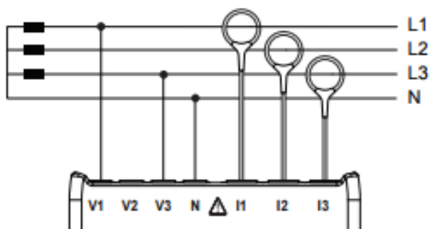
3.4 pav. PEL 103 prijungimas prie OPTIMUM F4 mašinos pagrindinio variklio
