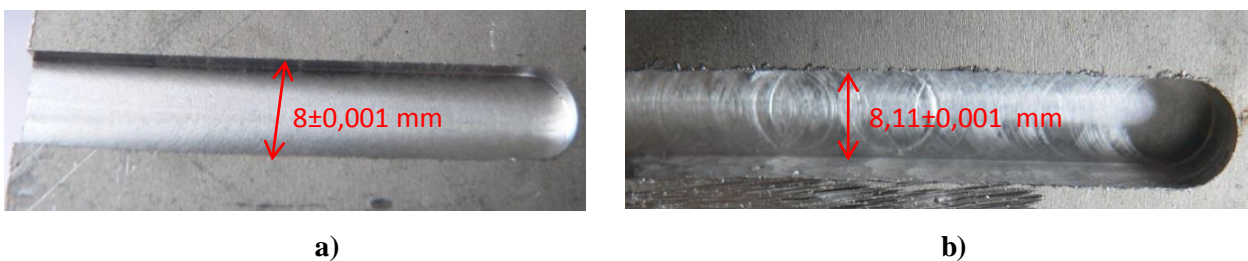
3.12 pav. Apdirbimo kokybė frezuojant aliuminį 8 mm a) „gera“ ir b) „bloga“ freza
