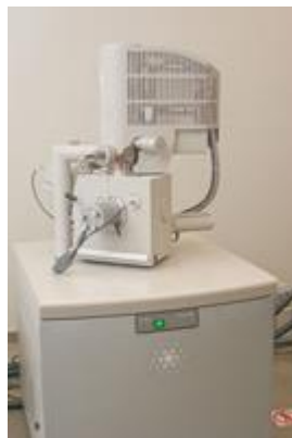
2.8.pav. Skenuojantis elektroninis mikroskopas FEI Quanta 200 FEG (SEM).
