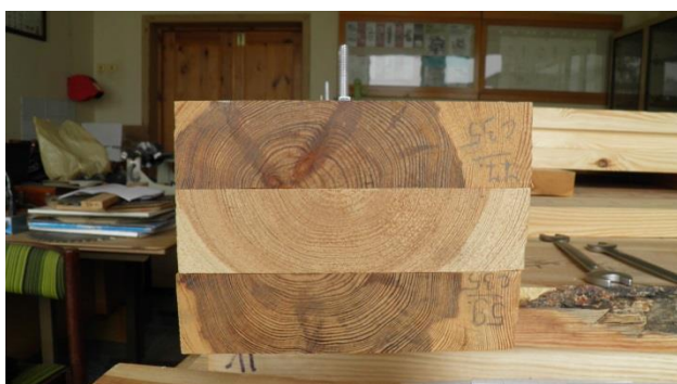
Pav. 2.9 Suvaržymas srieginiais strypais
