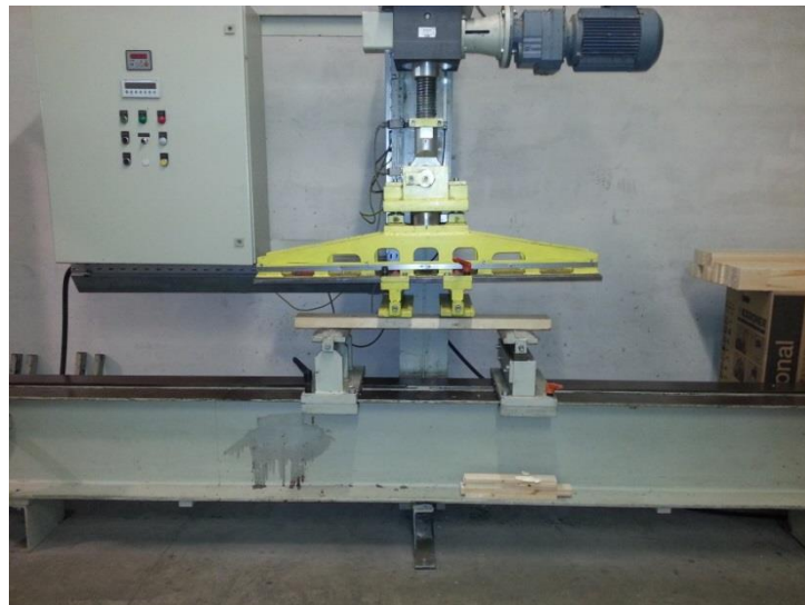
Pav. 2.16 Keturių taškų lenkimo bandymas
