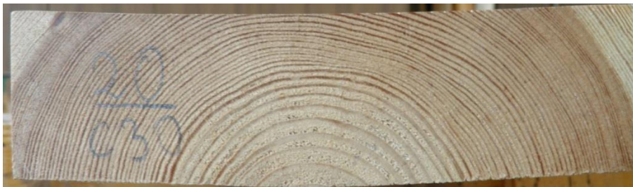
Pav. 2.6 Dėl nuodžiūvio išlinkusi lenta
