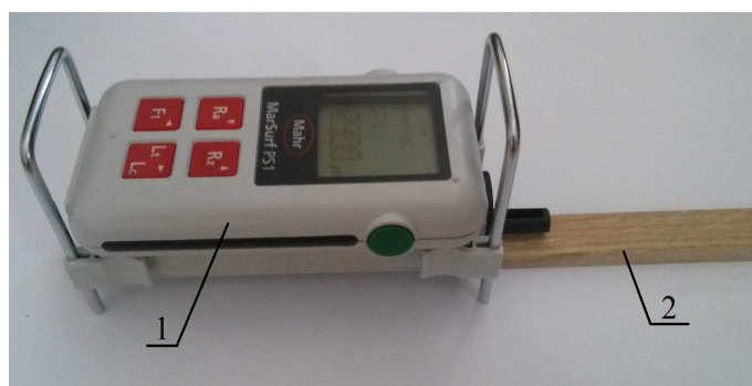
65 pav. Nufrezuoto paviršiaus šiurkštumo matavimas; 1 – šiurkštumo matuoklis; 2 – bandinys
