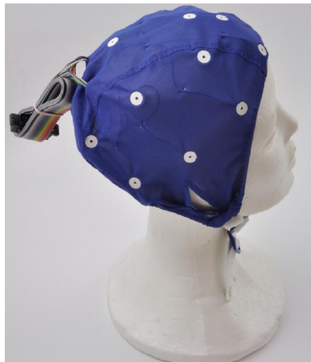
1.3 pav. EEG matavimo kepurė su įmontuotais elektrodais.
