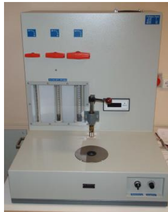
3.2 pav. Laidumo orui matavimo įrenginys L14DR
