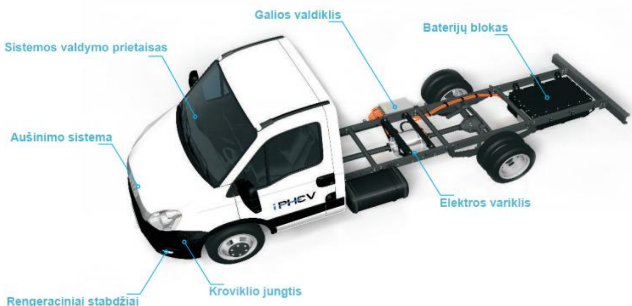
1.7 pav. Įmonės UAB „Elinta“ iPHEV sistema modifikuotame Iveco „Daily“ sunkvežimyje
