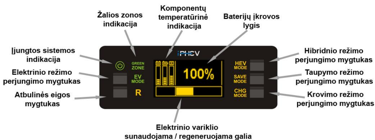
2.8 pav. Sistemos būsenos atvaizdavimo, režimų valdymo prietaisas
