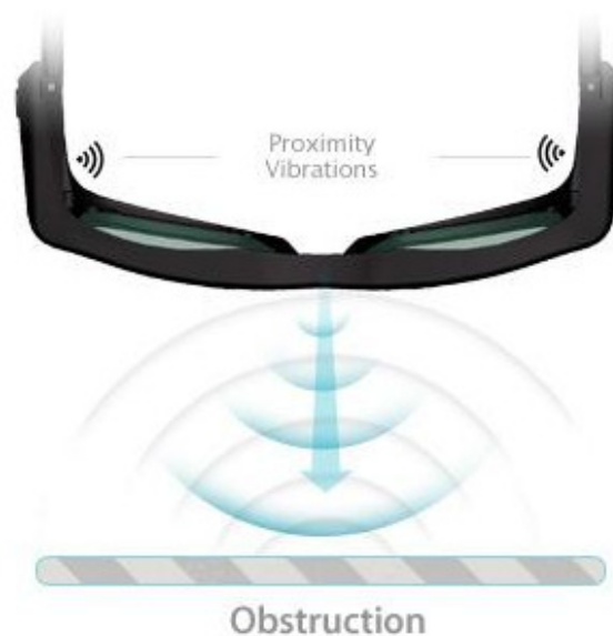
Pav. 1.7 Vibruojantys akiniai IGlasses™ [24]
