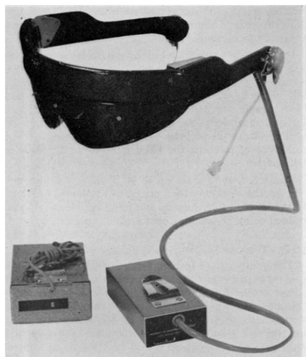
Pav. 1.6 Profesoriaus L. Kay suprojektuota aklojo „vedlio“ sistema [22]
