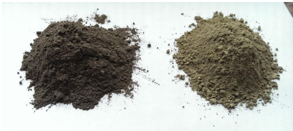
2.1.1 pav. Kairėje pusėje tamsesni, sijoti medienos pelenai, dešinėje cementas
