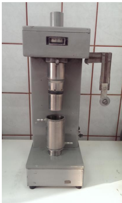
2.2.1.2 pav. Rotacinis viskozimetras su koaksialiniais cilindrais BCH-3
