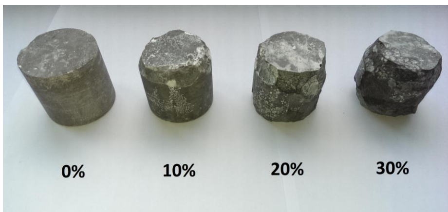
2.3.10.1 pav. Bandiniai po 6 šaldymo ciklų 3% NaCl tirpale
