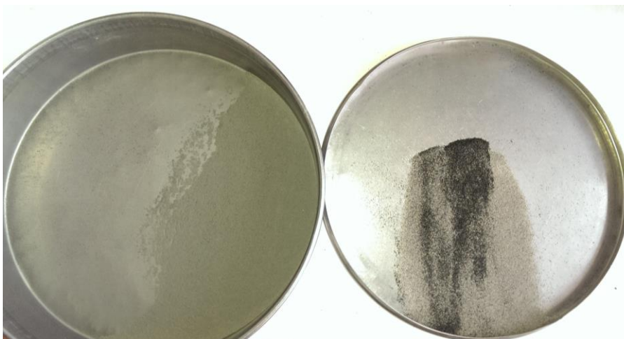
2.1.2 pav. Kairėje praėjusios dalelės per 125 \mu\text{m} sietą, dešinėje – likusios ant sieto
