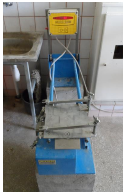
2.3.6.2 pav. Laboratorinis tankintuvas „Matest“
