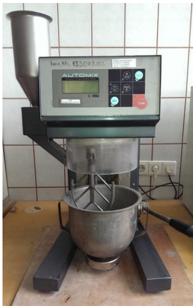
2.3.6.1 pav. Laboratorinė maišyklė „Automix“
