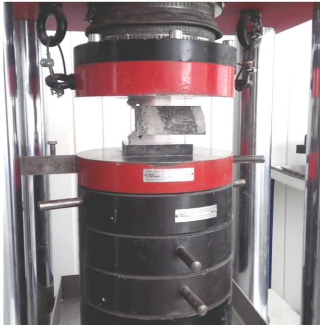
2.2.2.2 pav. Toni Technik įrenginiu gniuždomas bandinys
