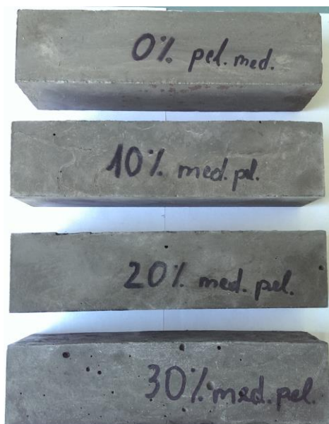
2.3.6.4 pav. Bandinių atspalvio pokytis su skirtingu pelenų kiekiu
