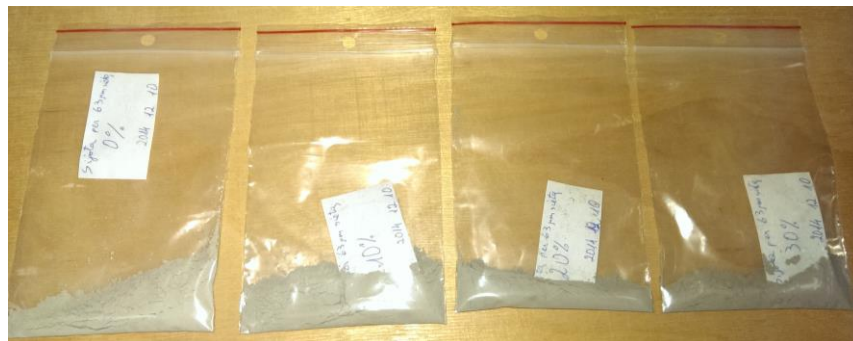
2.2.5.1 pav. Visų sudėčių sutrinto cementinio akmens milteliai paruošti rentgenografinėi analizei
