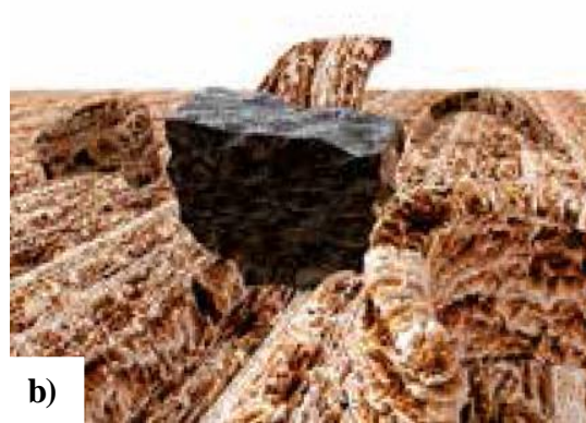
1.5.1 pav. a) Aliuminio oksido grūdelio pjovimo vaizdas; b) silicio karbido grūdelio pjovimo vaizdas [12]
