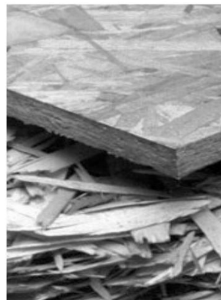
1.2.6 pav. Orientuotų skiedrantų plokštė (OSB) [4]
