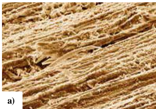
1.5.2 pav. a) Aliuminio oksido grūdelio suformuoto paviršiaus vaizdas; b) silicio karbido grūdelio suformuoto paviršiaus vaizdas [12]
