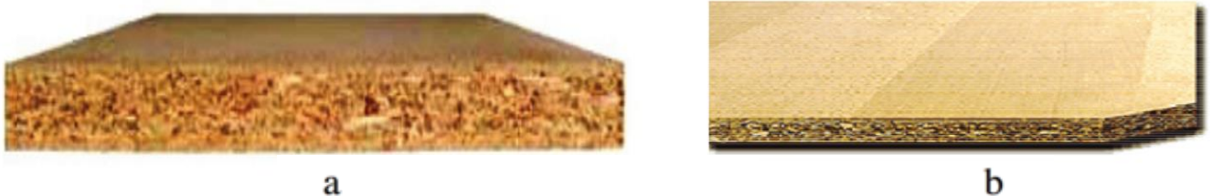
1.2.4 pav. Medienos drožlių plokštės: a - neapdailinta; b - faneruota [4]
