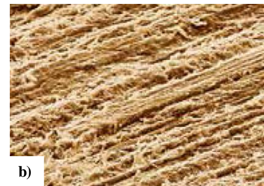
1.5.2 pav. a) Aliuminio oksido grūdelio suformuoto paviršiaus vaizdas; b) silicio karbido grūdelio suformuoto paviršiaus vaizdas [12]
