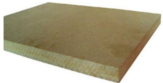
1.2.5 pav. Vidutinio tankio medienos plaušų plokštė (MDF) [4]
