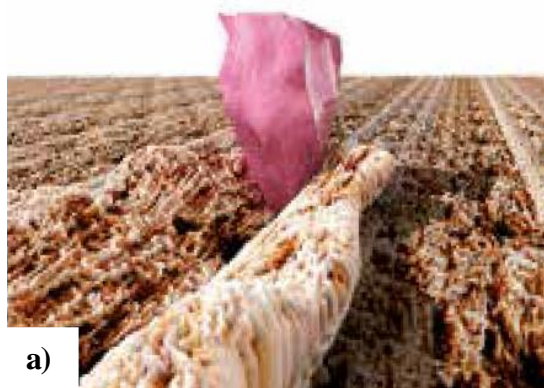
1.5.1 pav. a) Aliuminio oksido grūdelio pjovimo vaizdas; b) silicio karbido grūdelio pjovimo vaizdas [12]
