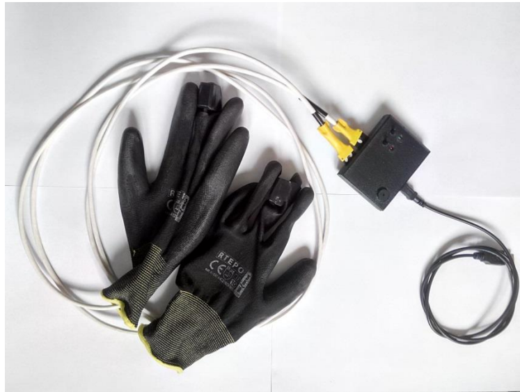
3.4 pav. Suprojektuota aparatinė dalis nuskaitanti rankų judesių signalus.
