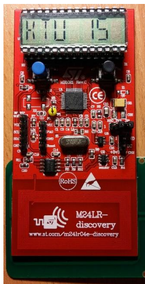
Pav. 8 M24LR duomenų gavimas iš RF siųstuvo
