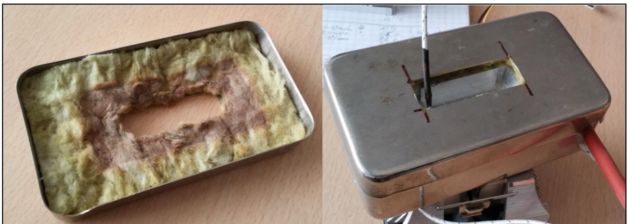
41 pav. Dešinėje dėžutės dangtelis su stiklo vata, kairėje uždarytoje dėžutėje kaitinimo plokštelė su pritvirtinta K tipo termopora prie kaitinimo reaktoriaus sienelių (pati dėžutės dangtelio išpjova bus patobulinta)
