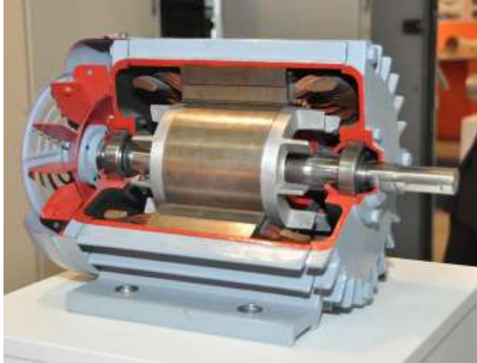
1.5 pav. Šiuolaikinio asinchroninio elektros variklio modelis [5]
