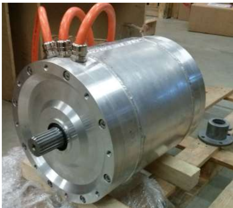
5.5 pav. Surinktas skysčiu aušinamas elektros variklis
