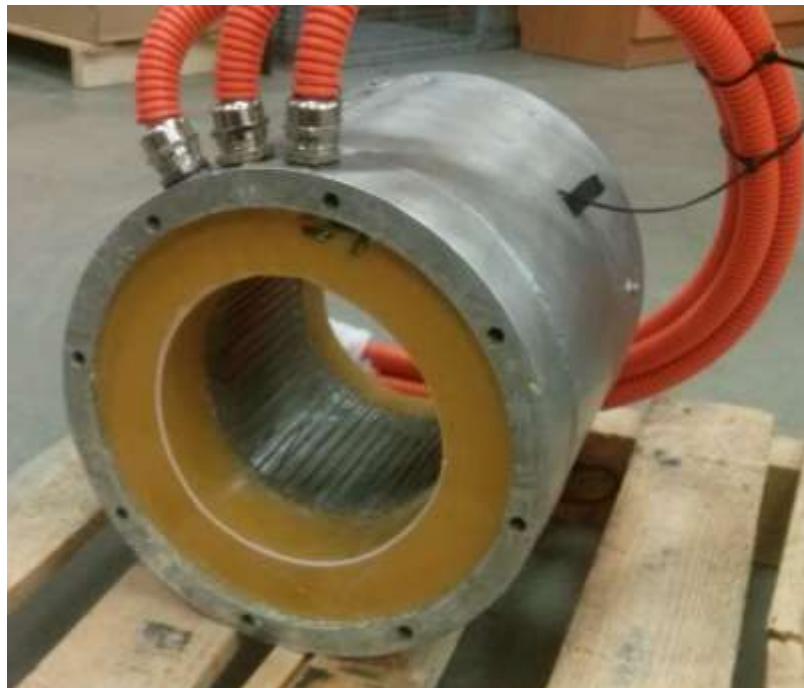
5.3 pav. Elektros variklio korpusas su užpiltomis apvijomis
