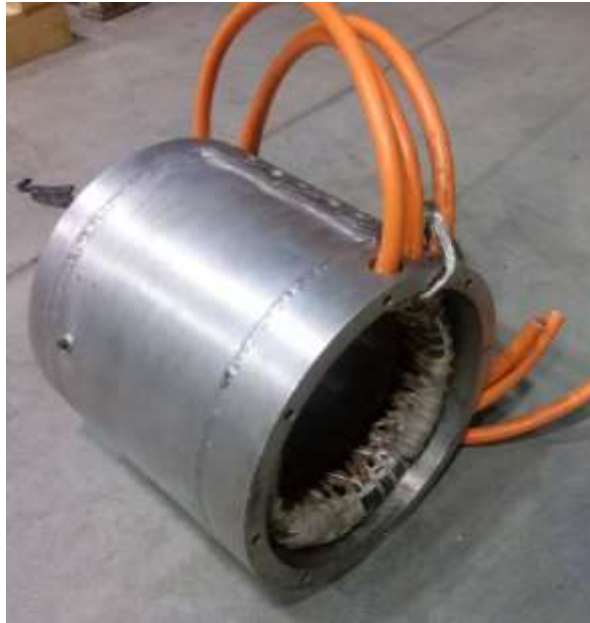
5.2 pav. Elektros variklio korpusas su statoriumi
