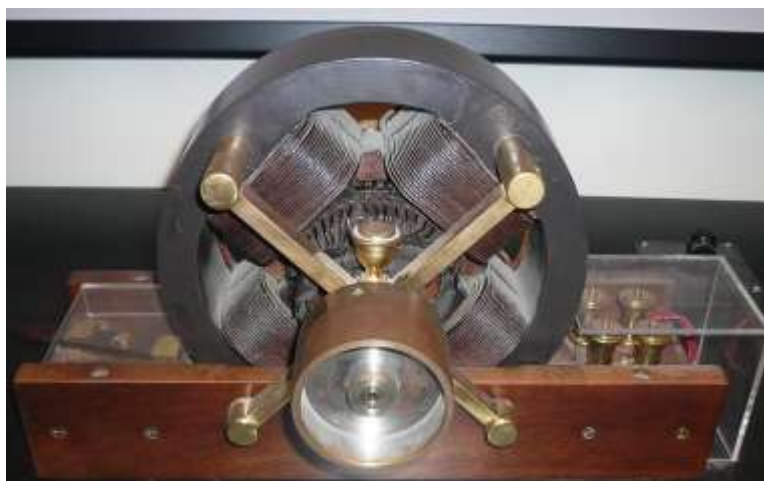
1.4 pav. Pirmojo Nikola Tesla sukurto asinchroninio elektros variklio modelis [4]
