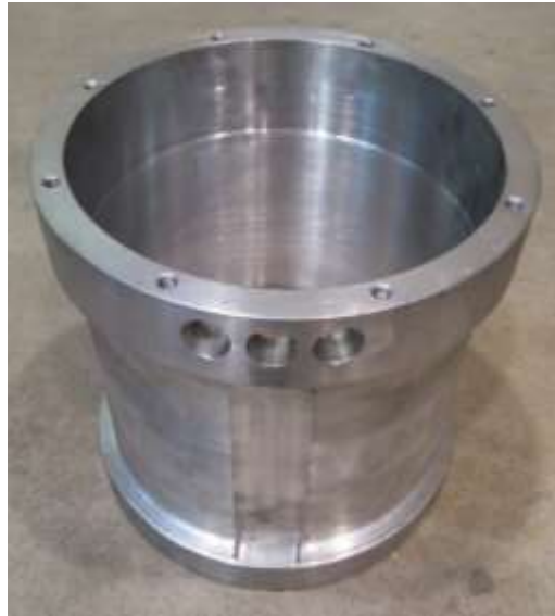
5.1 pav. Skysčiu aušinamo elektros variklio korpuso ruošinys
