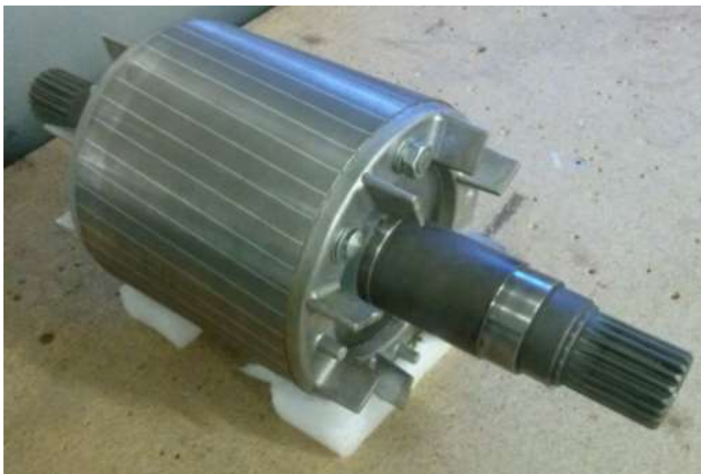
5.4 pav. Surinktas elektros variklio rotorius
