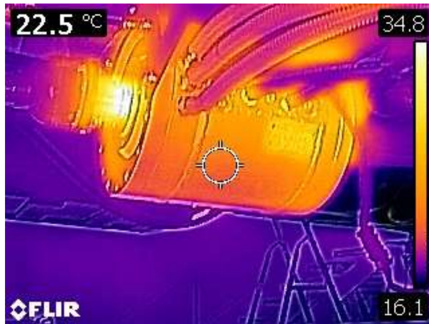
5.9 pav. Elektros variklio korpuso temperatūros pasiskirstymas
