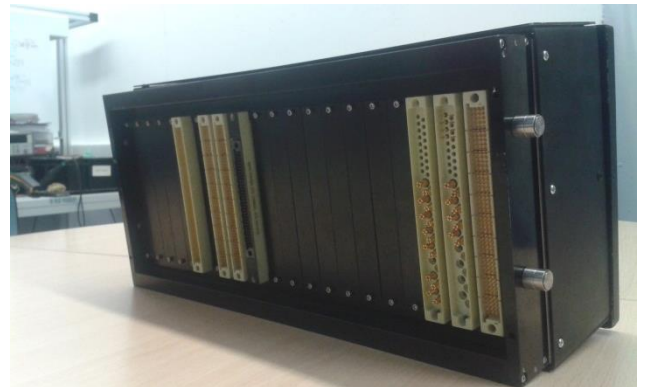
1.7 pav. SATS savipatikros testo adapteris (kairėje - vaizdas iš priekio, dešinėje - vaizdas iš jungties pusės)
