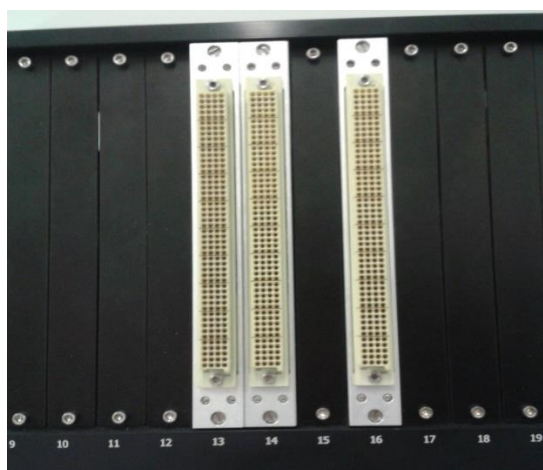
4.5 pav. SATS analoginių matavimų ir multiplexeri jungtyss
