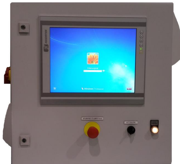
3.3 pav. Pramoninis kompiuteris vaizdų analizės atlikimui
