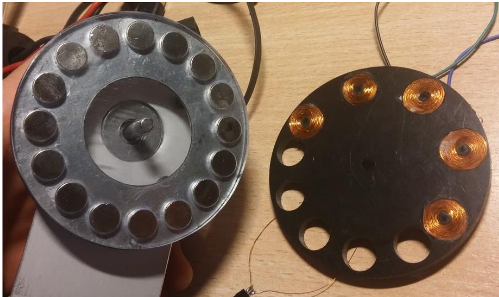
2.7 pav. Pagamintos energijos šaltinio rotorinė (kairėje) ir statorinė (dešinėje) dalys
