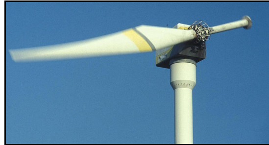
2.1.2 paveikslas. Vienos mentės vėjo elektrinė
