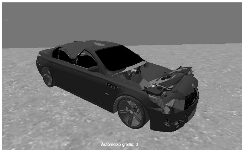
Pav. 6.6 Geometrinio objekto konstrukcijos rezultatai po geometrinės sferos objekto nukritimo ant nagrinėjamo objekto paviršiaus.
