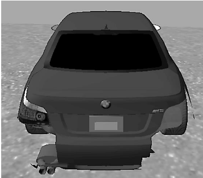
Pav. 6.3 Geometrinio objekto konstrukcijos elementų dingimas po kontakto
