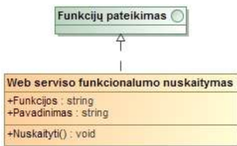
10 pav. Paketo “Funkcijų nuskaitymas” klasių diagrama
