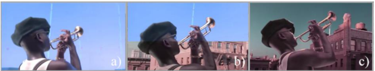
1.11 pav. Mėlynojo fono panaudojimas kuriant filmą The Great Gatsby : a – pradinė scena su mėlynu fonu; b – tarpinis komponavimo etapas; c – galutinis komponavimo rezultatas.
