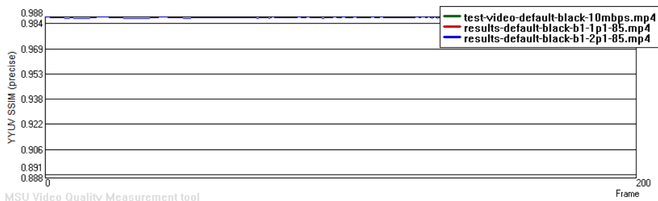
3.4 pav. Statistinio parametro 3SSIM reikšmių grafikas srities išskyrimą atlikus dviem skirtingais atvejais.
