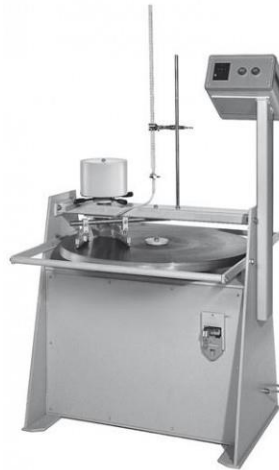
2.2 pav. Atsparumo dėvėjimuisi Böhme metodu nustatymo mašina.[24]
