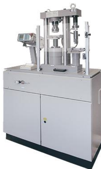
2.1 pav. Lenkimo – gniuždymo įrenginys.[23]
