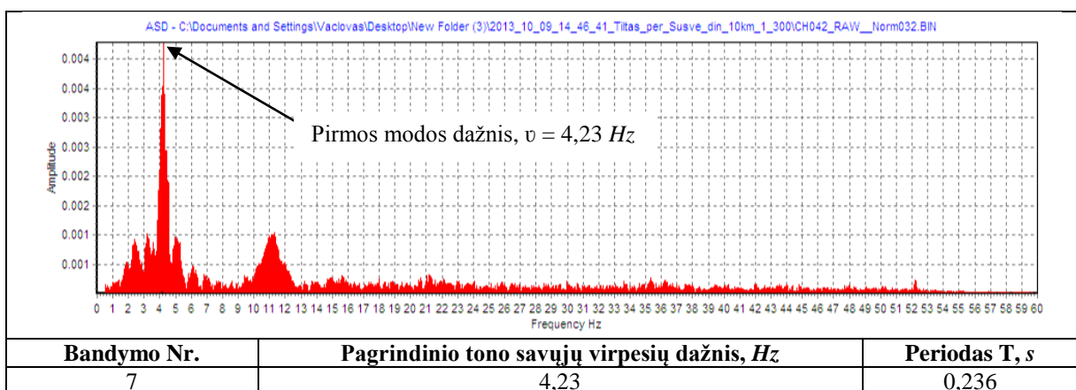
3.8 pav. Pagreičių jutikliu, pirmojo tarpatriamio perdangos viduriniame pjūvyje, užregistruotas perdangos virpesių grafikas
