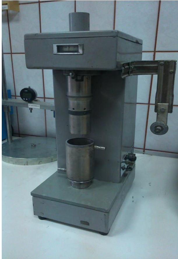
2.3.1 pav. Rotacinis viskozimetras BCH-3
