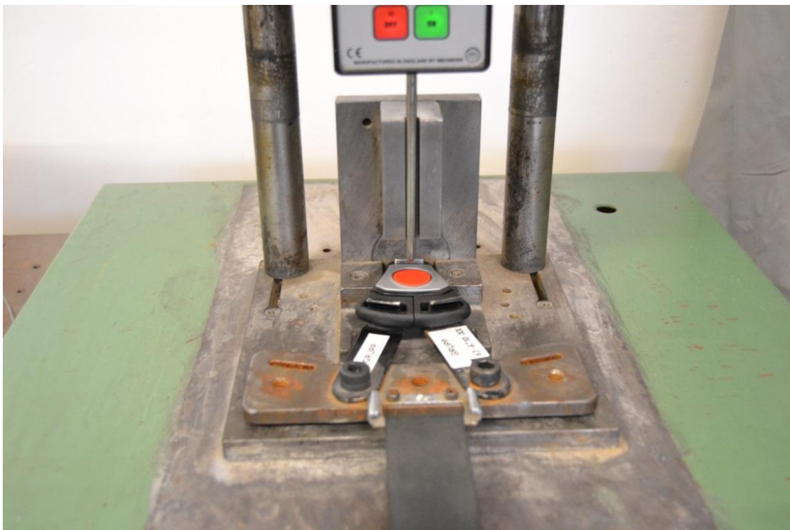
Pav. 2.12 Įmonės testavimo laboratorijoje esantis atsegimo bandymo įrenginys
