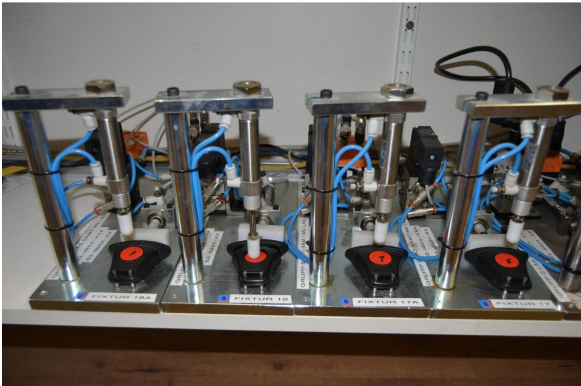
Pav. 2.11 Įmonės testavimo laboratorijoje esantys 5000 ciklų bandymo įrenginiai
