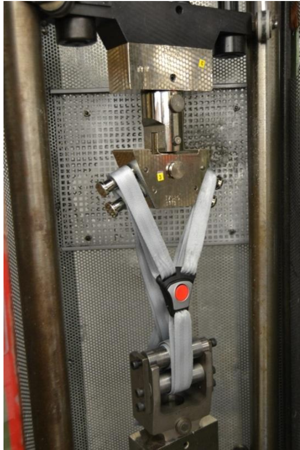
Pav. 2.15 Įmonės testavimo laboratorijoje esantis tiesaus traukimo įrenginys
