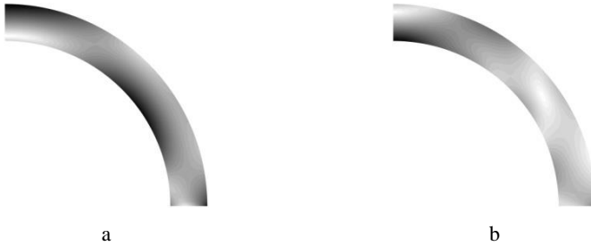
Fig. 25. Equivalent stress a) the first eigenmode, b) the fourth eigenmode
