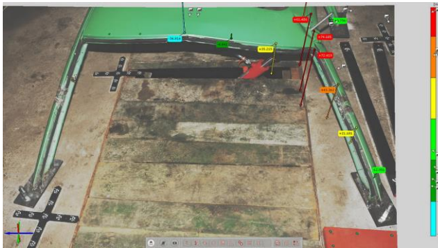
P.5 pav. Deformuotų automobilio stogų būdingų taškų poslinkiai (konstrukcija su suvirinimo siūlėmis išdėstytomis pagal 3 modelį)
