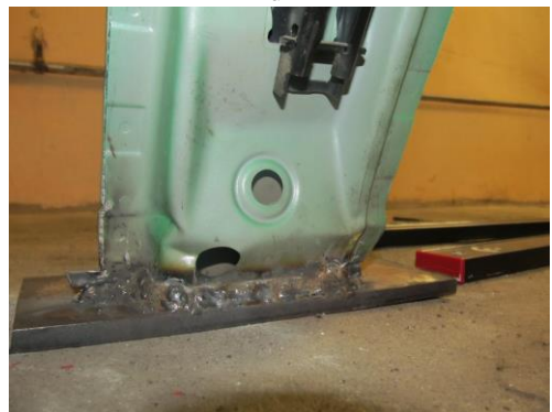
3.16 pav. Automobilio viduriniojo statramsčio deformacijos: a, b – gamyklinė konstrukcija; c, d – konstrukcija su suvirinimo siūlėmis apačioje; e, f – konstrukcija su suvirinimo siūlėmis per vidurį
