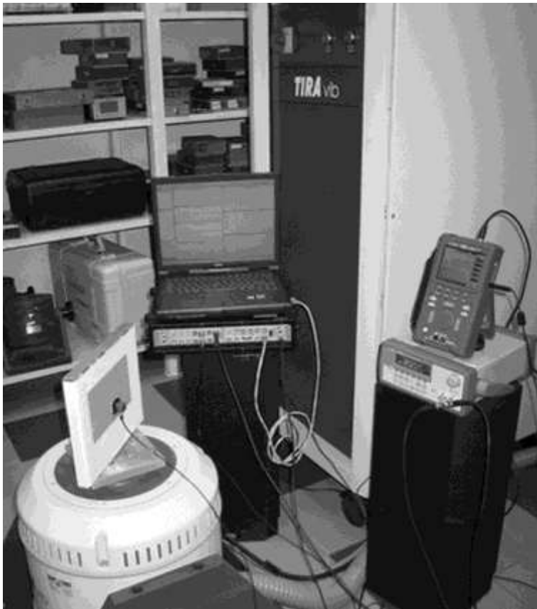
4.10 pav. Eksperimentinė įranga konstrukcijos patikimumui patikrinti
