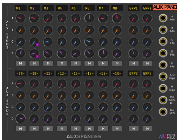
7 pav. AUX valdymo skydelis ir signalo išsiuntimo parametrai
