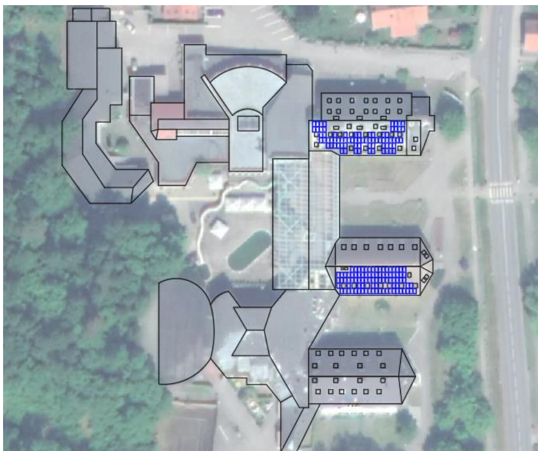
29 pav. Saulės modulių išdėstymas ant poilsio namų „Ažuolynas“ pirmojo ir antrojo korpusų pietinės stogo dalies
