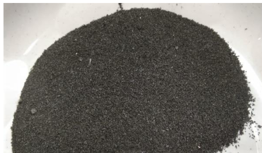
Fig. 2. 2. Crumb rubber ( <0.315\text{mm} )
