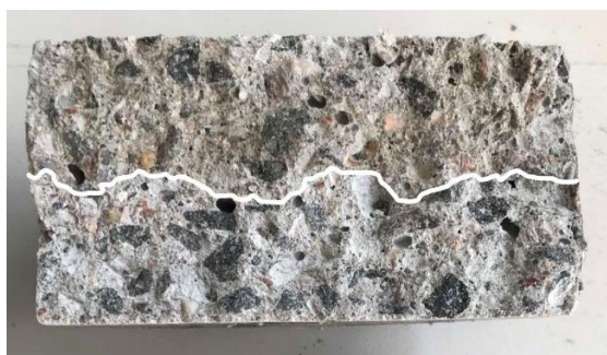
35 pav. Tirto IV sudėties bandinio bandomasis paviršius
