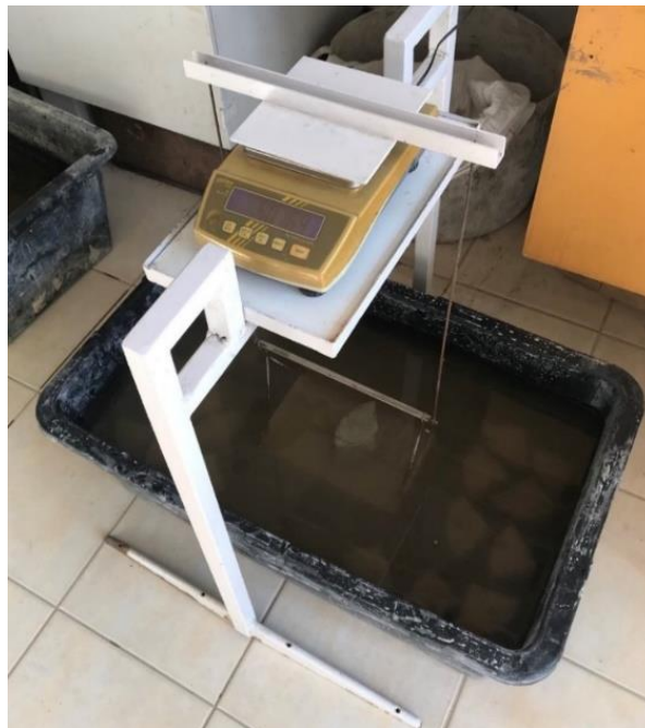
26 pav. Torkretbetonio bandinių svėrimas vandenyje
