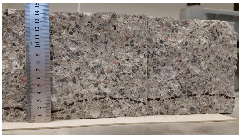
19 pav. Gniuždomojo stiprio rezultatai po atsparumo šalčiui bandymo
