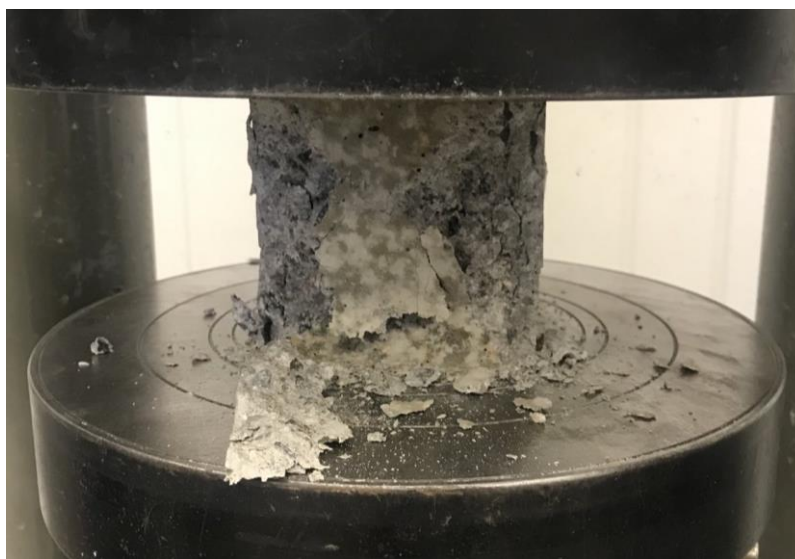
13 pav. Laboratorijoje formuotų torkretbetonio bandinių gniuždomojo stiprio nustatymas
