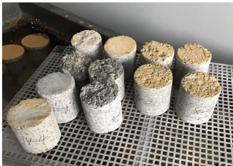
17 pav. Bandiniai po tūrinio šaldymo ir atšildymo bandymo
