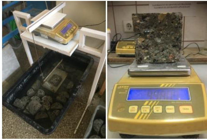
39 pav. Bandinių svėrimas: a) vandenyje, b) ore
