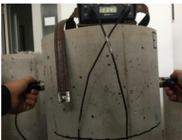
23 pav. Ultragarso impulso bangos tyrimas kolonomis dedant keitiklius priešingose kolonos pusėse
