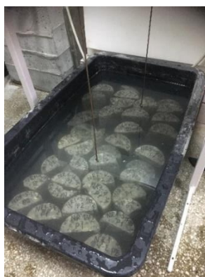
38 pav. Bandiniai sudėti į indą su vandeniu ir mirkomi
