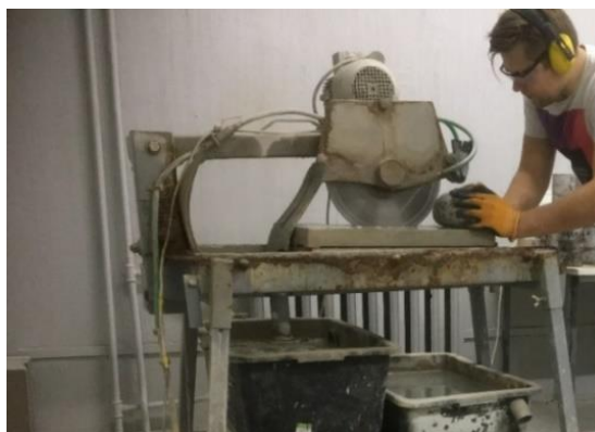
29 pav. Kernų pjaustymas betono pjovimo staklėmis
