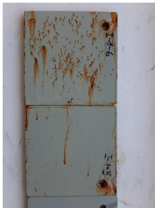
5.8.1 pav. Bandinys džiovintas kameroje po 144 val. veikimo. 5.8.2 pav. Bandinys džiovintas kameroje po 500 val. veikimo.
