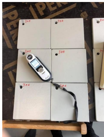
4.2.8.2 pav. Spalvos kodo matavimo procesas
