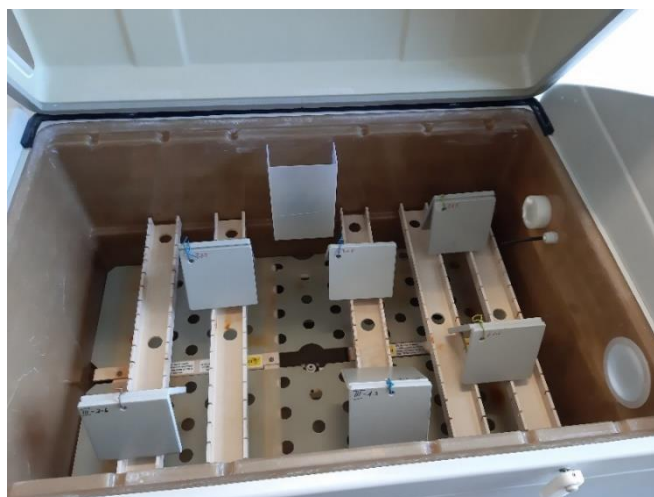
4.2.9.1 pav. Sudėti bandiniai į rūko kamerą.
