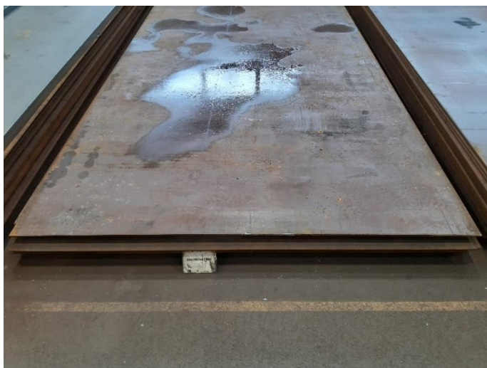
4.2.1.1 pav. Plieno lakšas (10mm storio) bandiniams
