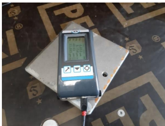
4.2.4.2 pav. Paviršiaus šiurkštumo nustatymo procesas, matuojant matuojkliu.
