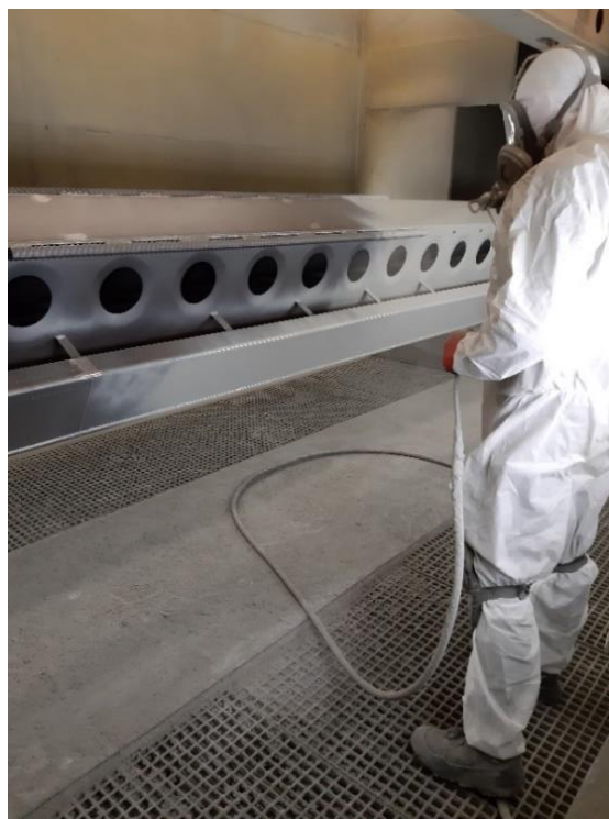
4.2.5.2 pav. Dažymo proceso eiga
