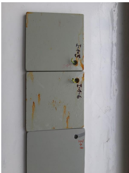
5.8.1 pav. Bandinys džiovintas kameroje po 144 val. veikimo. 5.8.2 pav. Bandinys džiovintas kameroje po 500 val. veikimo.
