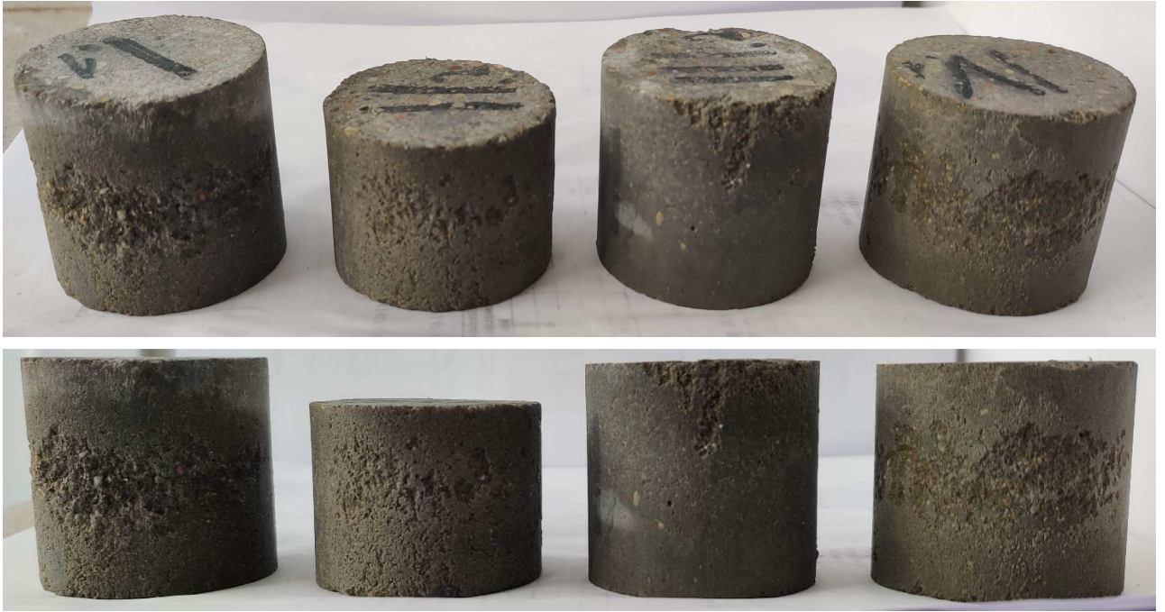
40 pav. Atrinkti prasčiausiai atrodantys bandiniai po 28 ciklų
