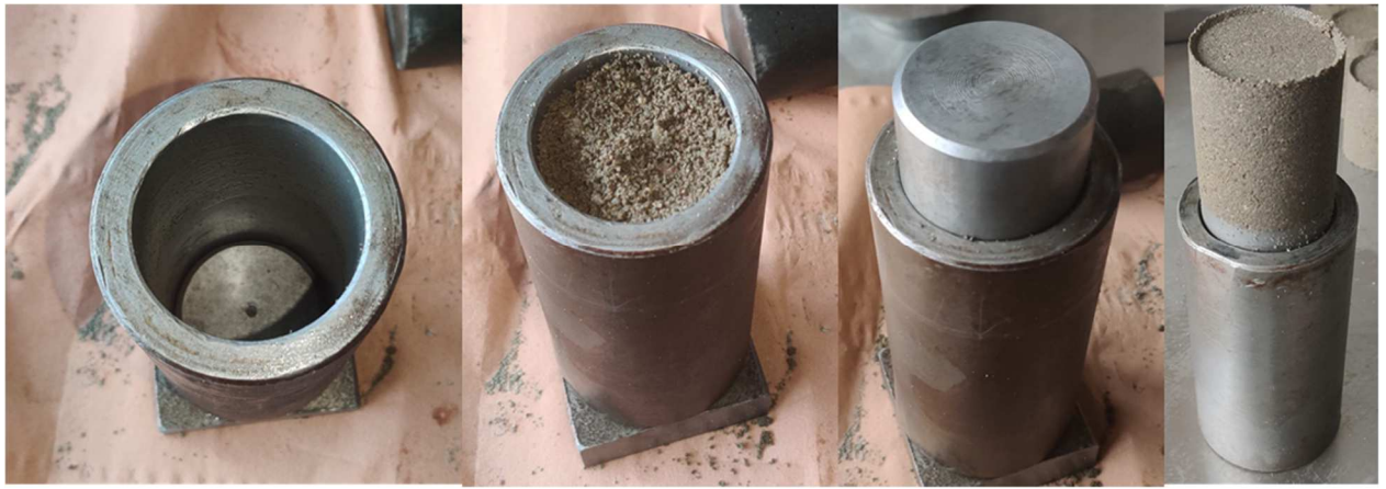
9 pav. Bandinių formavimas cilindrinėje formelėje
