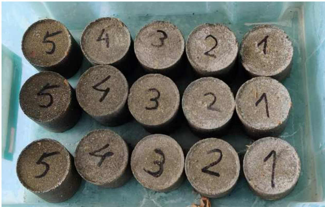
30 pav. Betonų atsparumo šalčiui nustatymas po 0 ciklų
