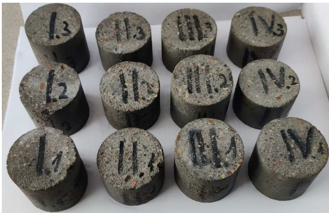
39 pav. Bendras bandinių vaizdas po 28 šaldymo-atšildymo ciklų
