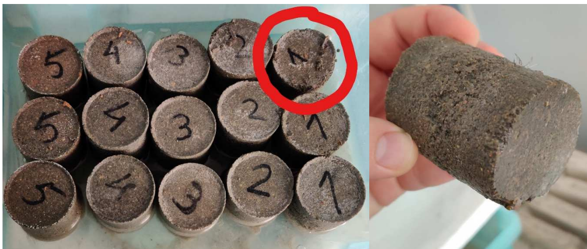
32 pav. Betono atsparumo šalčiui nustatymas po 13 ciklų
