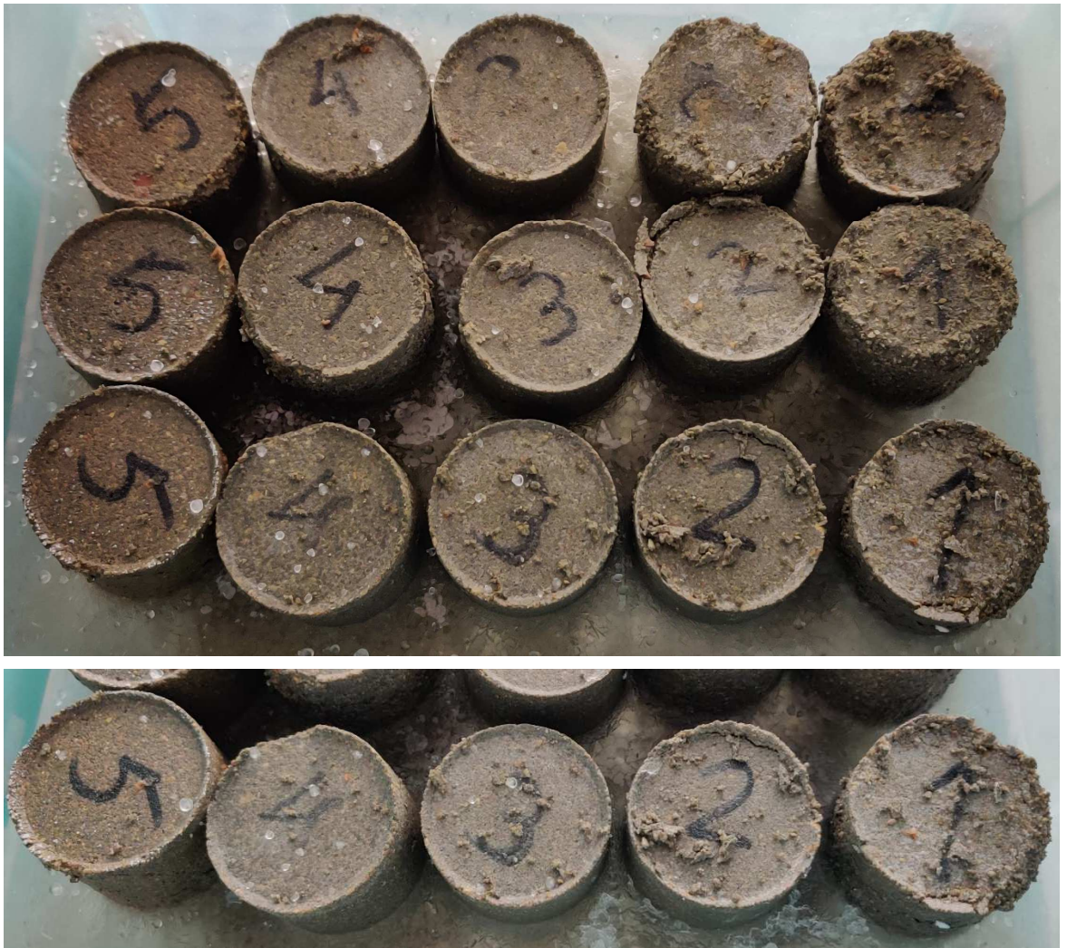
36 pav. Betono atsparumo šalčiui nustatymas po 37 ciklų
