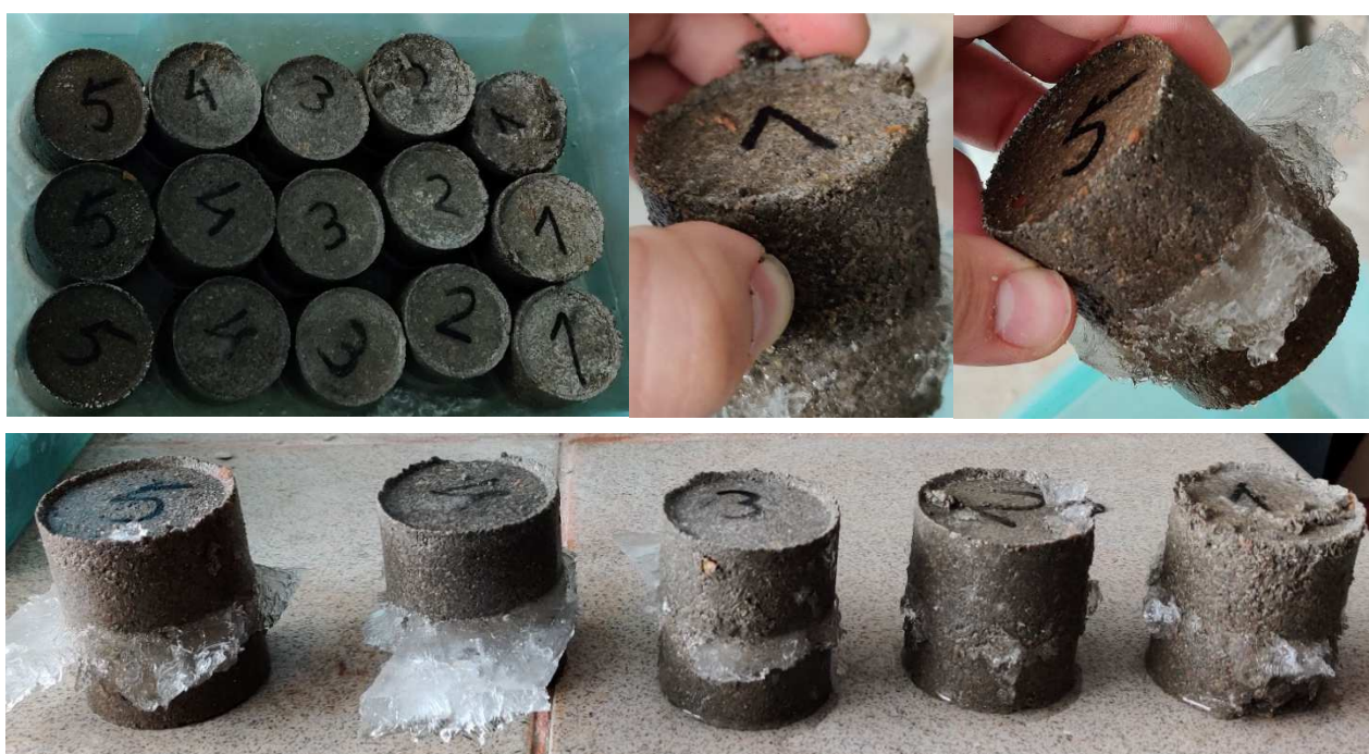
33 pav. Betono atsparumo šalčiui nustatymas po 21 ciklų
