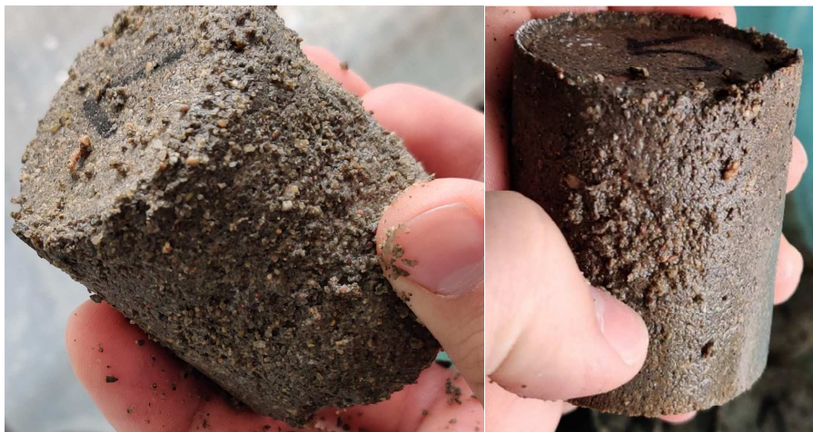
35 pav. Betono atsparumo šalčiui nustatymas po 28 ciklų. 1 ir 5 var.
