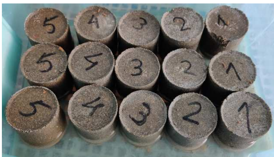
31 pav. Betonų atsparumo šalčiui nustatymas po 4 ciklų
