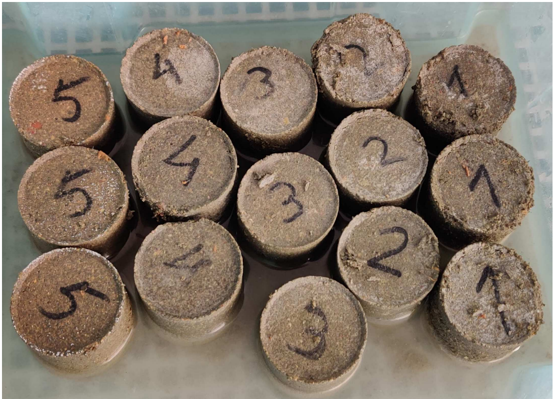
34 pav. Betono atsparumo šalčiui nustatymas po 28 ciklų
