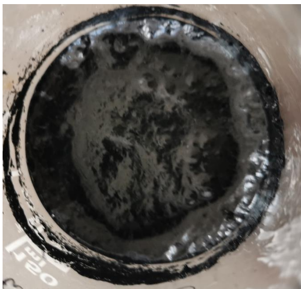
16 pav. Anglies nanovamzdeliai natrio šarme po dispergavimą ultragarsu
