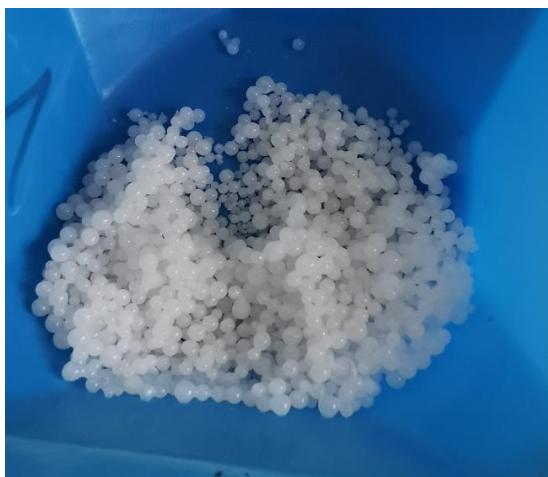
4 pav. Natrio šarmo granulės maišomos su vandeniu, kad gauti natrio šarmo tirpalą
