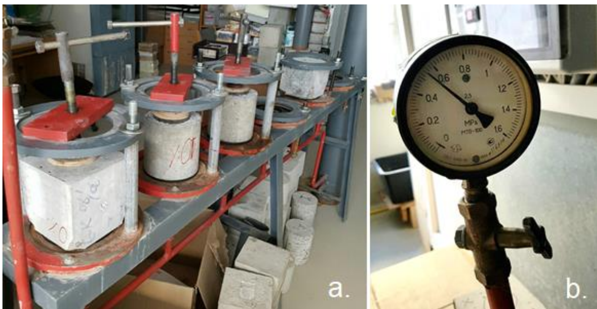
14 pav. Vandens įsiskverbimo į betoną gylio nustatymo bandymų stendas (a) su slėgio įranga (b)
