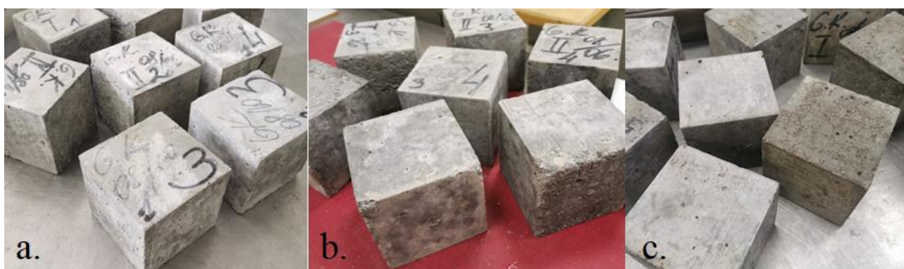
26 pav. Atsparumo šalčiui tyrimo bandiniai po a) 100; b) 150 ir c) 200 užšaldymo / atšildymo ciklų
