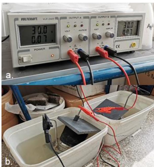
10 pav. Chlorido jonų prasiskverbimo gylio bandymas: a) Elektros srovės šaltinis Voolcraft VLP-2043, b) sujungti bandiniai
