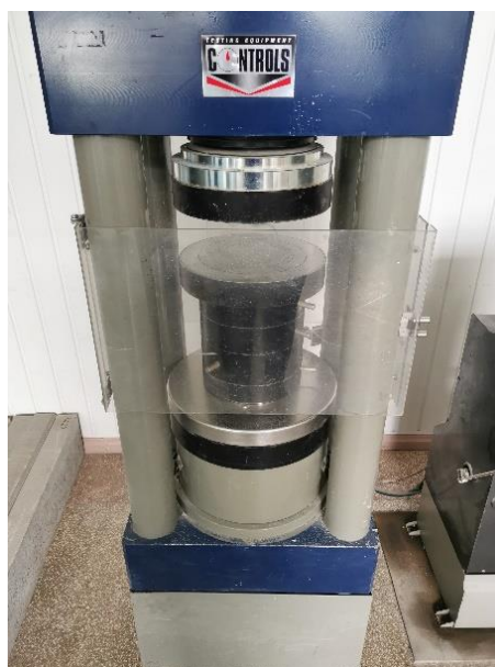
9 pav. Hidraulinis presas Controls “PILOT4”
