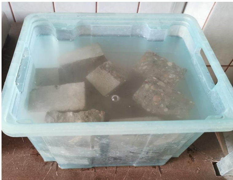
12 pav. Bandiniai pamerkti į vandenį
