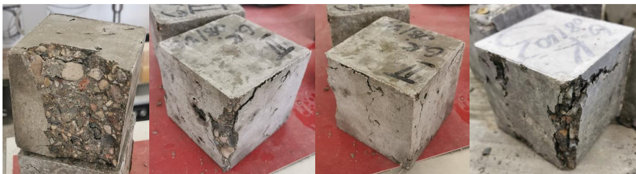
20 pav. Sugniuždyti betono bandiniai
