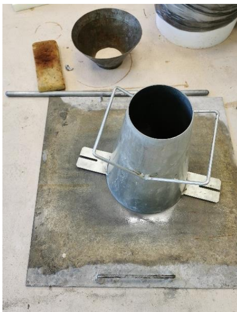
5 pav. Betono mišinio slankumo nustatymo įranga: kūgio forma, pagrindo plokštė, tankinimo strypas, piltuvas, kempinė
