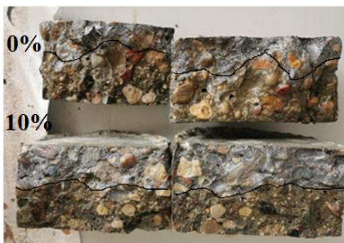
21 pav. Chloridų įsiskverbimo gylio nustatymo bandiniai su 0 proc. ir 10 proc. dugno pelenų
