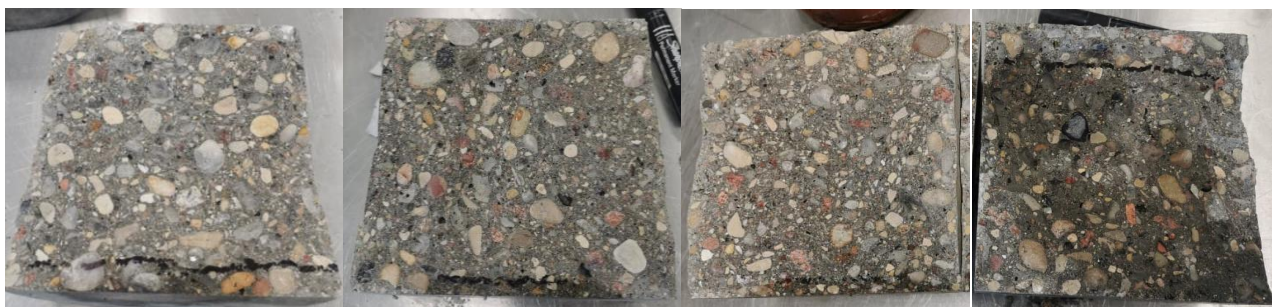
25 pav. Vandens įsiskverbimo gylio nustatymo bandiniai
