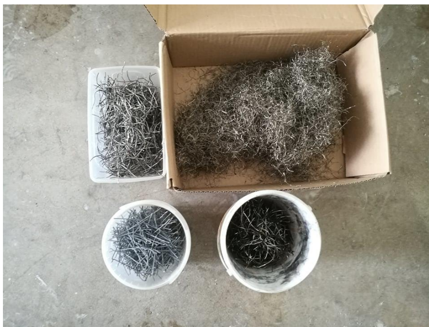
28 pav. 300g skirtingų diametrų fibrų tūrinis palyginimas (kairėje viršuje – padangų kordai, 0,7 \text{ mm} \leq \varnothing \leq 1,4 \text{ mm} ; kairėje apačioje – sertifikuotos fibros, \varnothing = 1 \text{ mm} ; dešinėje viršuje – padangų kordai, \varnothing \approx 0,35 \text{ mm} ; dešinėje apačioje – padangų kordai, 1,4 \text{ mm} < \varnothing < 2,1 \text{ mm} ;) )
