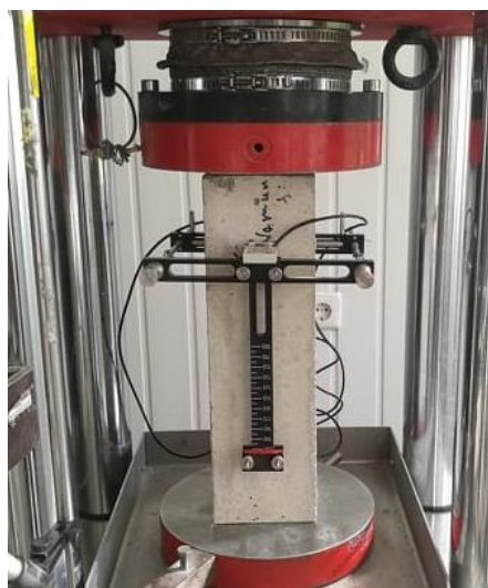
26 pav. Tamprumo modulio nustatymo bandymas
