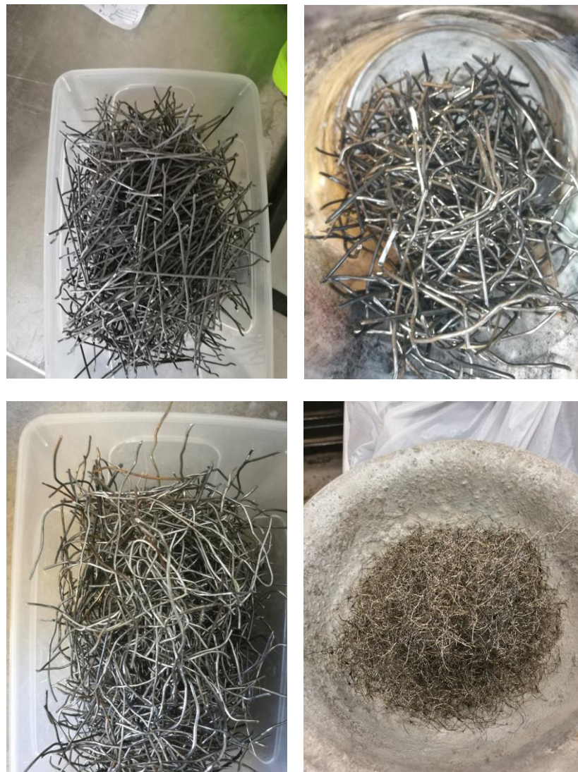
27 pav. Naudojamos fibros (kairėje viršuje – sertifikuotos fibros, \varnothing = 1 mm; dešinėje viršuje – padangų kordai, 1,4 \text{ mm} < \varnothing < 2,1 mm; kairėje apačioje – padangų kordai, 0,7 \text{ mm} \leq \varnothing \leq 1,4 mm; dešinėje apačioje – padangų kordai, \varnothing \approx 0,35 mm;)
