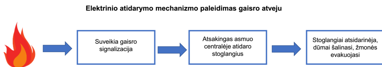
39 pav. Elektrinio atidarymo mechanizmo paleidimo schema (autorius Vytenis Bagdonas) 2020.
