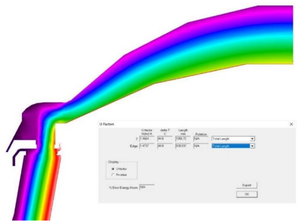
53 pav. Stoglangio SOLIDM modeliavimas programa „Therm“. Termonuotraukos modeliavimas, U vertės skaičiavimas (autorius Vytenis Bagdonas, 2020).
