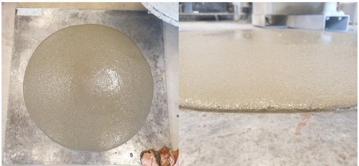
20 pav. Betono mišinio pasklidimas
