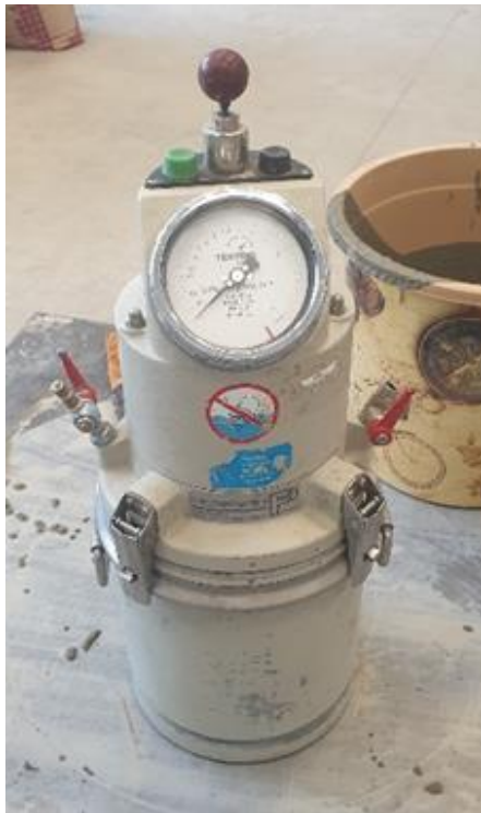
18 pav. Oro kiekio matavimo indas ir jo schema: 1 – ventilis A, 2 – ventilis B, 3 – pompa, 4 – pagrindinis oro ventilis, 5 – manometras, 6 – oro kamera, 7 – oro išleidimo ventilis, 8 – prispaudimo mechanizmas, 9 – prailgintas kalibravimo vamzdelis, 10 – indas [34]
