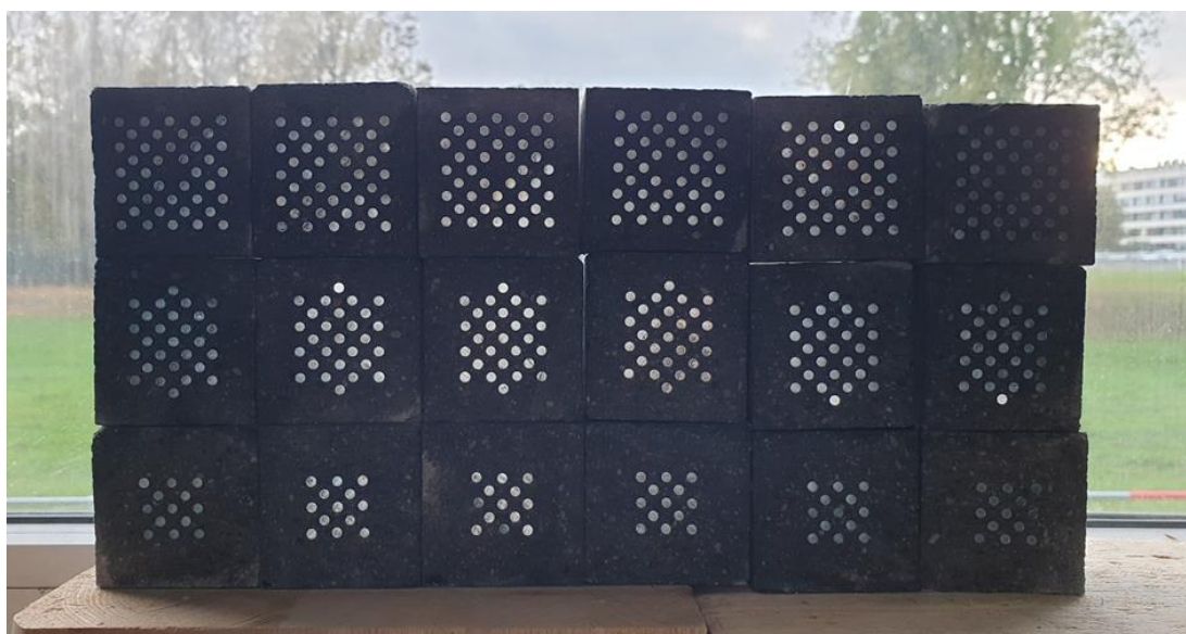
34 pav. Šviesai laidaus betono bandiniai – su 2 %, 4 % ir 6 % pluošto (žiūrėti iš apačios į viršų)
