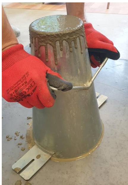
21 pav. Kūgis užpildytas betono mišiniu
