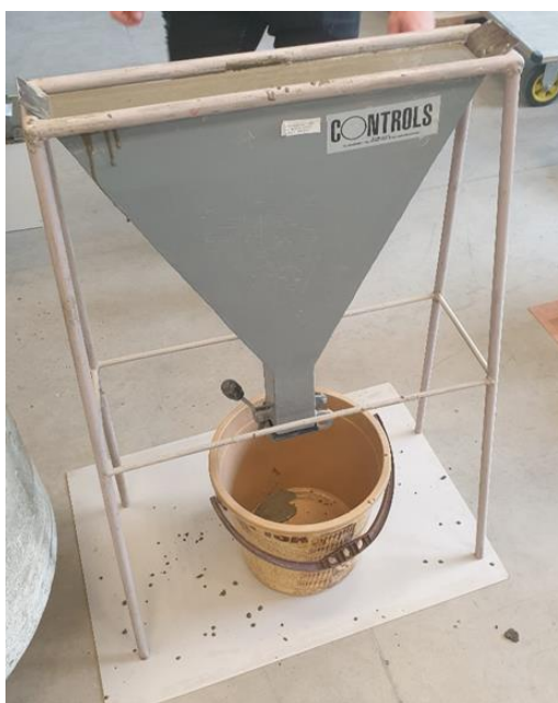
23 pav. V pavidalo piltuvai užpildyti betono mišiniu
