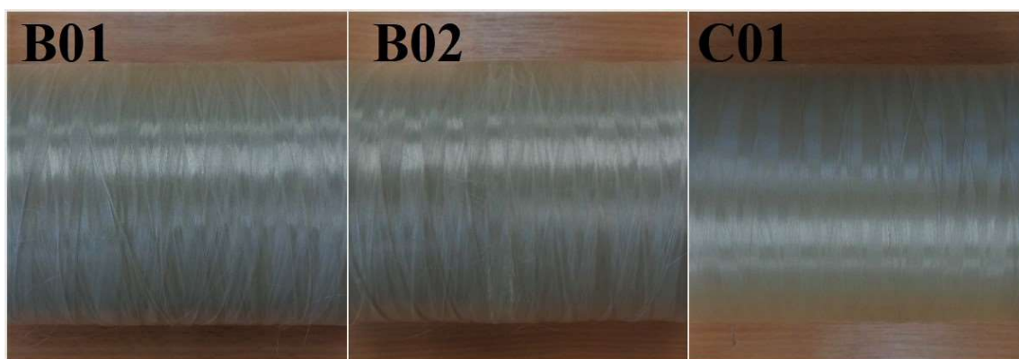
3.3 pav. Siūlų ričių palyginimas. Nekompaktiškų siūlų ritės B01 ir B02, kurios paviršiuje matomos sutrūkinėjusios gijos, kompaktiškų siūlų ritė C01, kurios paviršius tolygus.
