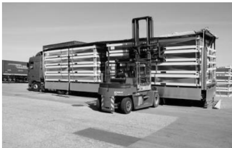
9 pav. Konteinerių sukrovimas „Transpack“ būdu [8]
