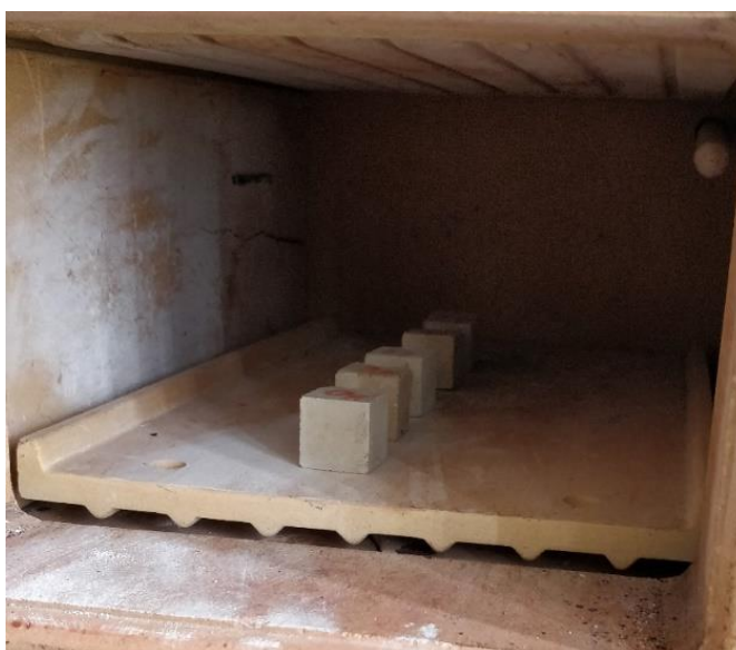
38 pav. Šarmu aktyvuotos medžiagos bandinių kaitinimas krosnelėje „SNOL 1,6.2,5./11-13“
