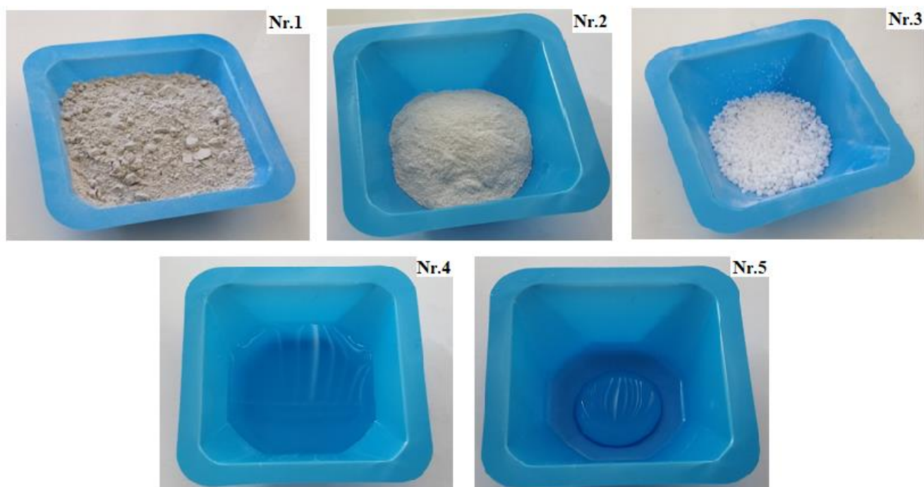
14 pav. Baigiamajame darbe naudojamos medžiagos: 1-šlakas, 2-fosfogipsas, 3-granuluotas natrio šarmas (NaOH), 4-vanduo (H 2 O), 5 – vandenilio peroksidas (H 2 O 2 )
