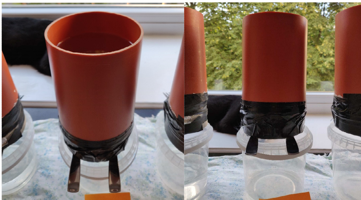
16 pav. Cementinės tešlos bandinių vandens pralaidumo bandymas
