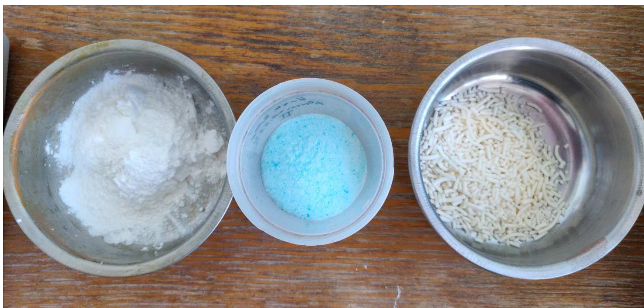
13 pav. Antrojo etapo bandinių gamyboje naudotos medžiagos. Iš kairės: kalcio stearatas, maltas amorfinis silicio dioksidas ir natrio alginatas
