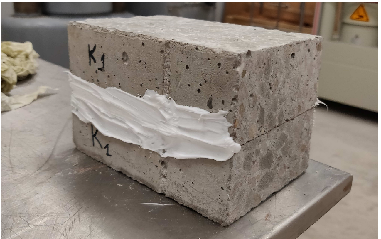
25 pav. Užsandarinami plyšio kraštai prizmės formos bandiniuose
