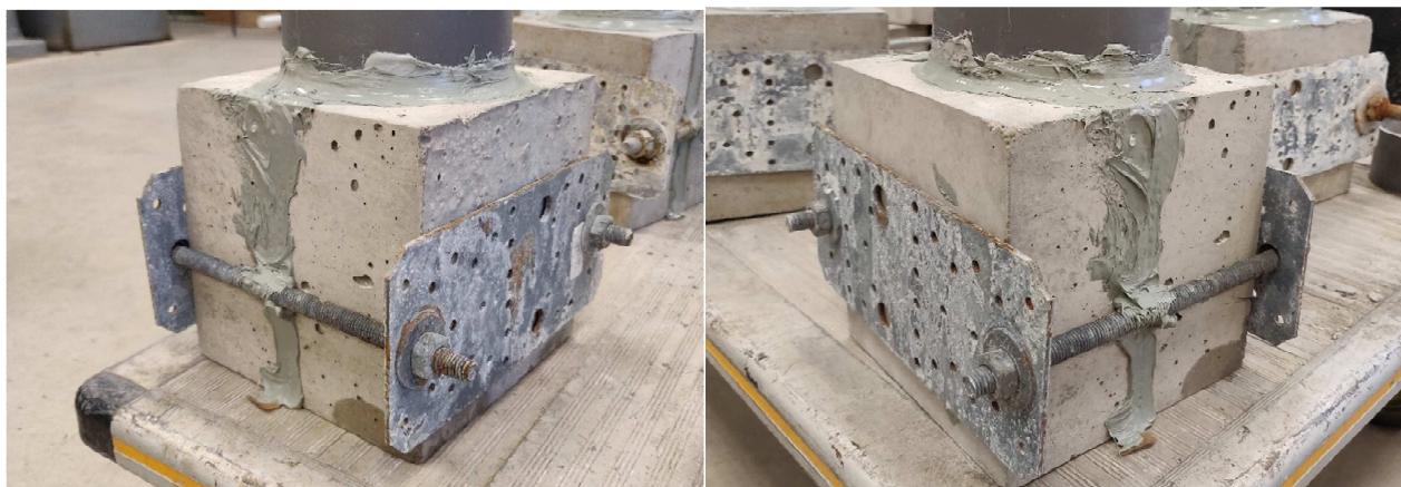
22 pav. Suformuoti skelto plyšio bandiniai, reikiamą plyšio plotį užtikrinant metalinių plokštelių bei sriegtų strypų pagalba
