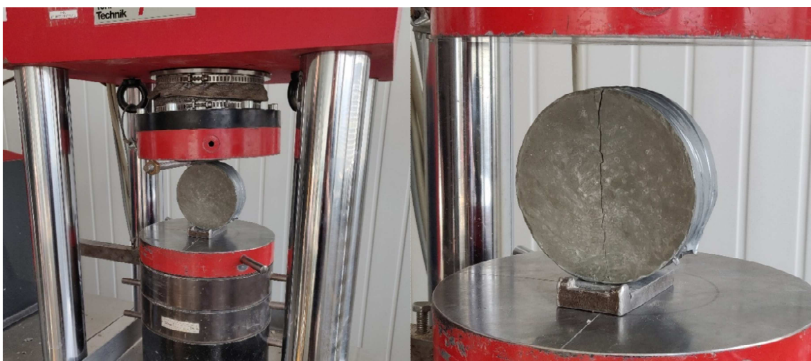
14 pav. Plyšio suformavimas skėlimo metodu
