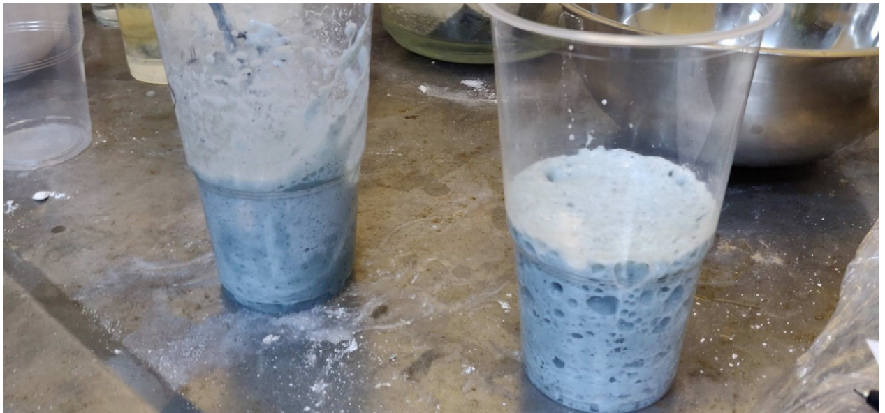
19 pav. Valgomosios sodos ( NaHCO_3 ) ir kalcio chlorido ( CaCl_2 ) tirpalų reakcija maltame amorfiniame silicio dioksido ( SiO_2 )
