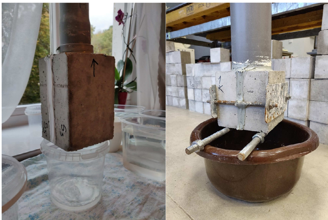
26 pav. Vandens pralaidumo bandymas: kairėje – lygaus plyšio bandinys; dešinėje – skelto plyšio bandinys
