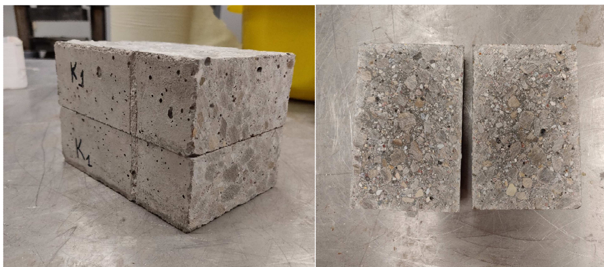
23 pav. Lygaus plyšio suformavimas perpjovus prizmės formos bandinius
