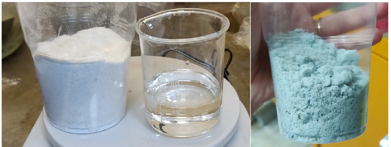
20 pav. Ketvirtoje bandinių sudėtyje naudotos medžiagos. Iš kairės: maltas amorfinis silicio dioksidas; trietanolaminas; dviejų medžiagų mišinys, naudotas bandinių gamybos metu
