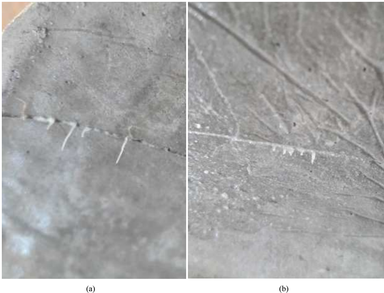
30 pav. Kristalų susidarymas plyšio išorėje dalinai pamerktuose bandiniuose po 28 parų: (a) – B sudėties bandinys; (b) – S sudėties bandinys
