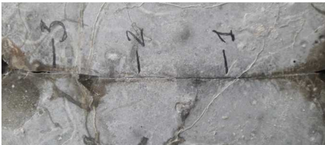
31 pav. Ore esančio S sudėties bandinio paviršius po 28 parų
