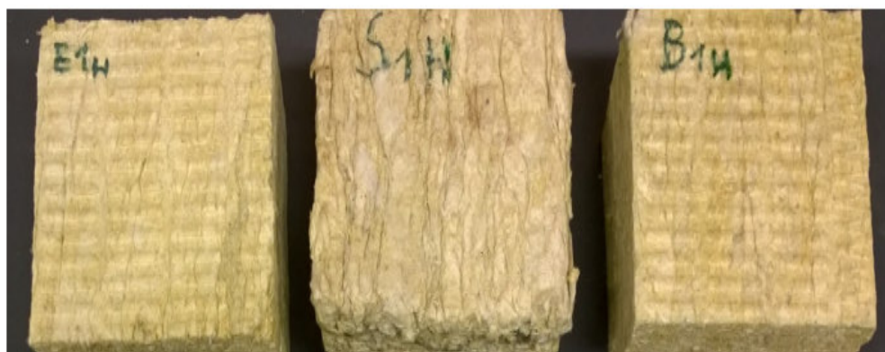
21 pav. Mineralinės vatos bandiniai [46]: A – etaloninis mėginys; B – pakitusios mineralinės vatos mėginys; C – mineralinės vatos mėginys, paimtas iš gyvenamojo namo išorės sienos karkaso
