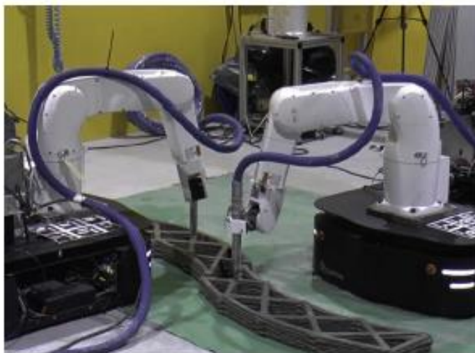
8 pav. Spausdinimas naudojant tik pagrindinę medžiagą [2]
