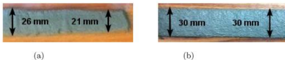
14 pav. Išspaudžiamumo testas. (a) – iškreiptas sluoksnis, (b) – gerai išspausdintas sluoksnis [18]
