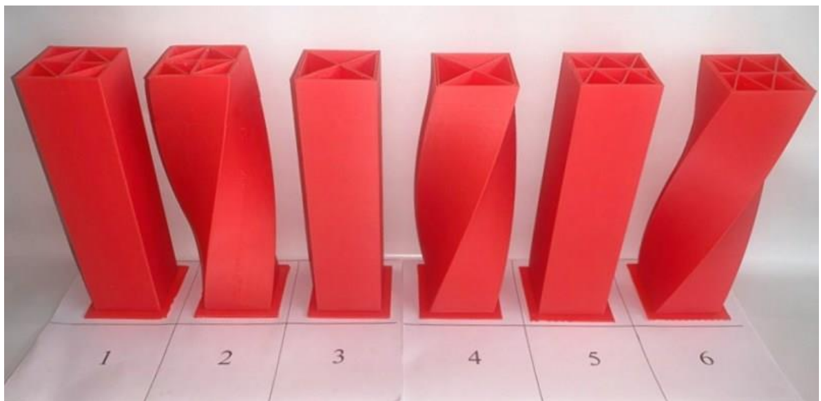
26 pav. Nagrinėjami skirtingų formų kolonų prototipai išspausdinti 3D spausdintuvu [sukurta autoriaus]
