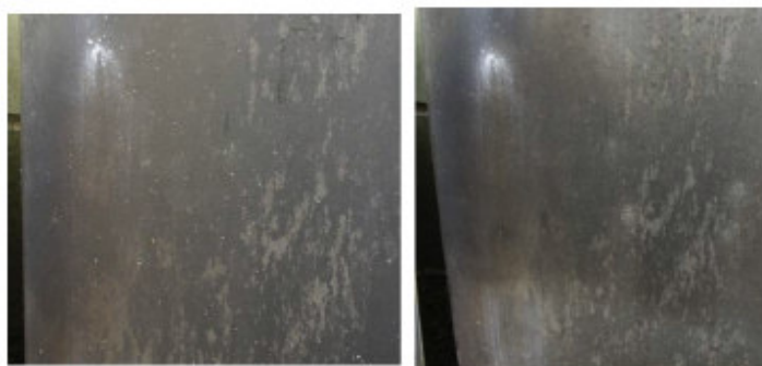
16 pav. Klojinio paviršiaus vaizdas prieš ir po padengimo tepalu augalinio aliejaus pagrindu [10]
