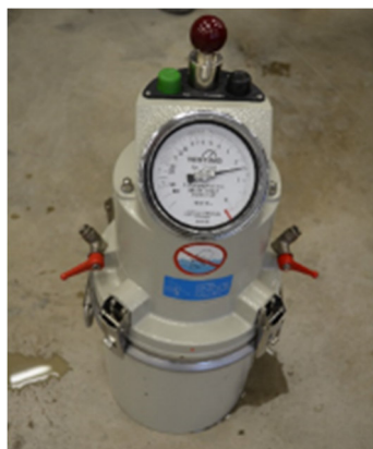
46 pav. Monometro metodas įtraukto oro betono mišinyje nustatymui
