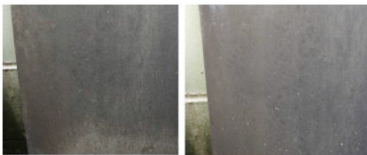
15 pav. Klojinio paviršiaus vaizdas prieš ir po padengimo sintetinė alyva [10]
