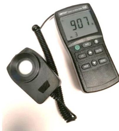
12 pav. Šviesos matuoklis „Unitest 93560 Luxmeter”
