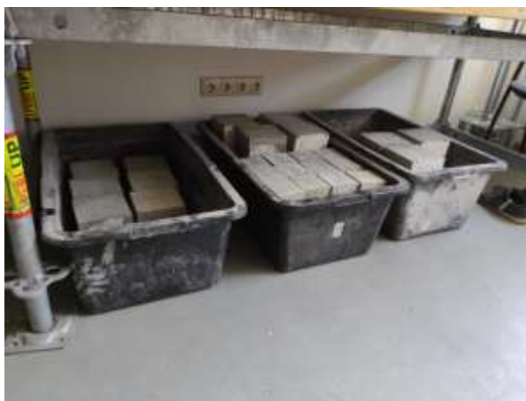
38 pav. Betono mišinio ruošimo ceche suformuoti bandiniai
