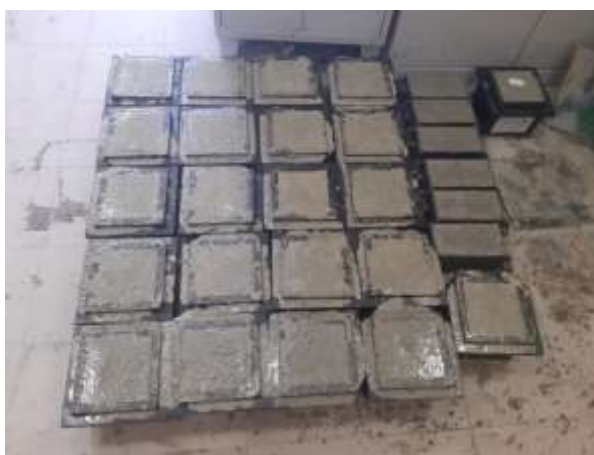
38 pav. Betono mišinio ruošimo ceche suformuoti bandiniai
