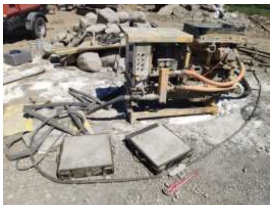
31 pav. Statybos aikštelėje suformuoti bandiniai
