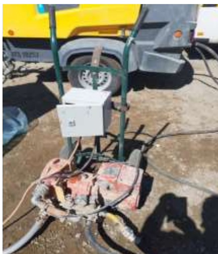
32 pav. Rišimasi greitinančios įmaišos padavimo į tutą siurblys
