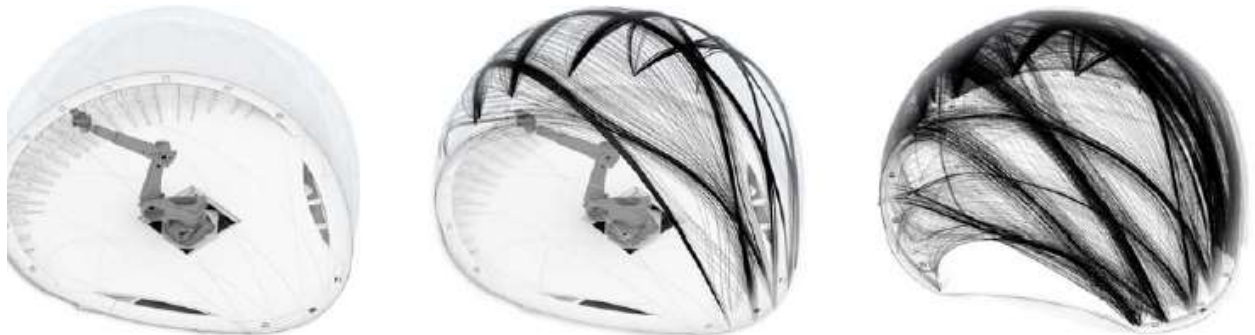
9 pav. 2014/15 m. ICD / ITKE tyrimų paviljono statybos metodas, Štutgarto universitetas [5].
