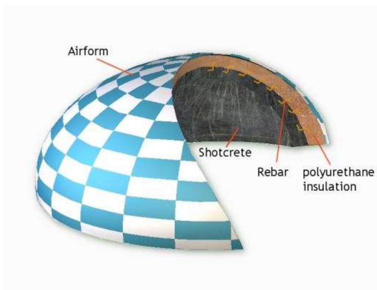
12 pav. Monolitinio kupolo konstrukcija paliekant membraną išorėje
