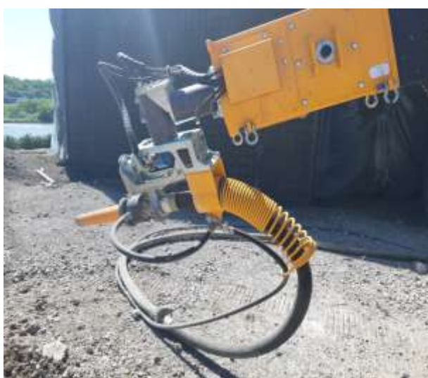
33 pav. Betono mišinio purkštuvus – su hidrauliniu valdymo mechanizmu
