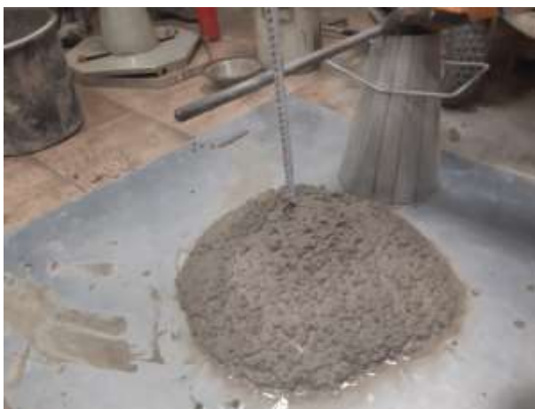
40 pav. Betono mišinio slankumo nustatymas
