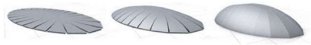
14 pav. Sukietinto betono (PFHC) konstrukcijos metodo pneumatinis formavimas [7].
